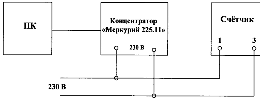
Рисунок А.1 - Схема для проверки функционирования PLC-модема
