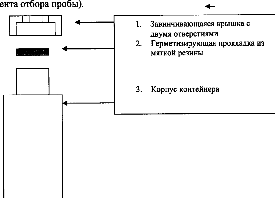
Рисунок 1. Схема контейнера для отбора проб с герметизирующей прокладкой.
