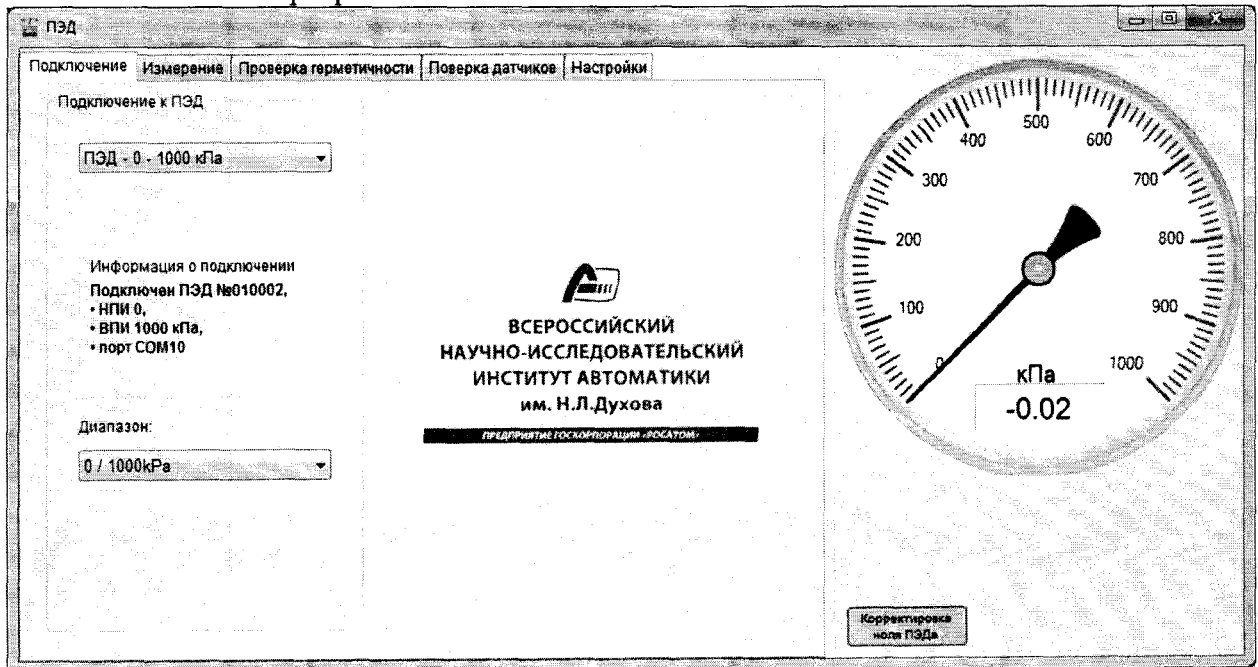
Рис. А.4 – Установка связи с ПЭД
