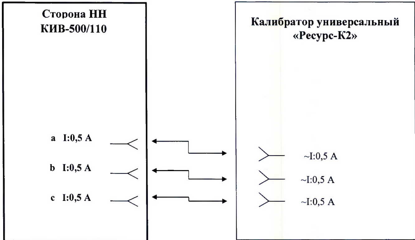
Рисунок А2 - Схема подключения прибора измерительного КИВ-500/110 (по стороне НН) к калибратору универсальному «Ресурс-К2» для определения допускаемой относительной погрешности измерений силы переменного тока (тока утечки)
