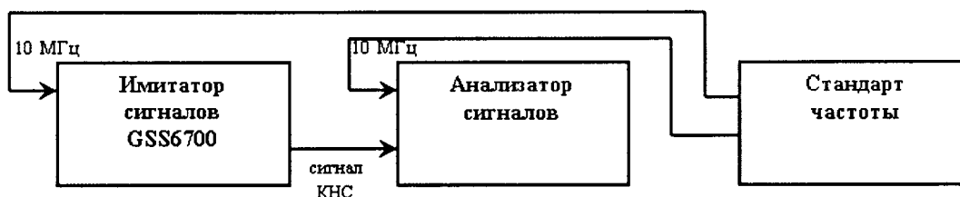
Рисунок 2 – Схема измерений для определения уровня гармонических составляющих
