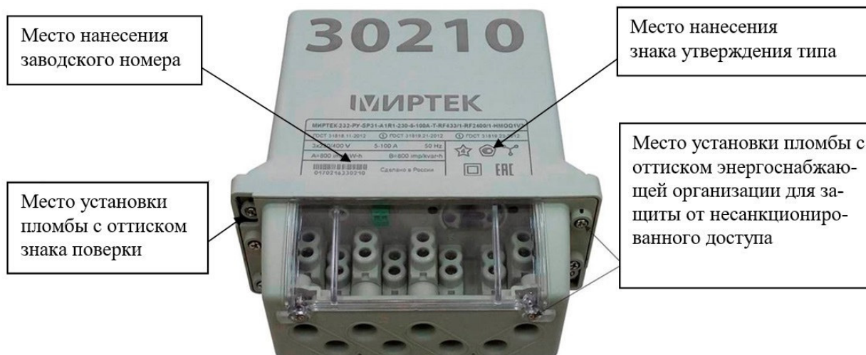
Рисунок 9 – Общий вид счетчика и схема пломбировки от несанкционированного доступа в корпусе типа SP31
