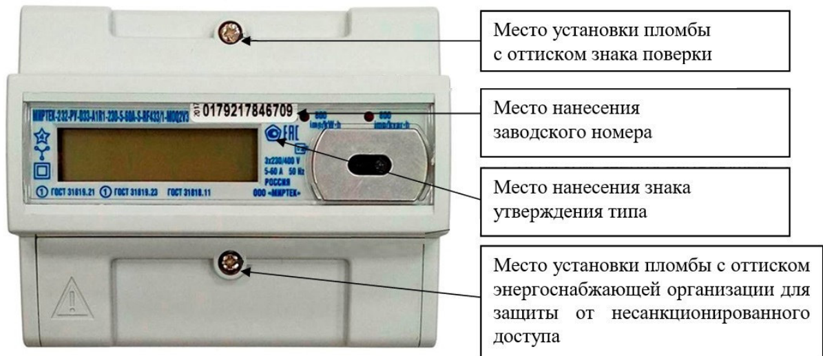
Рисунок 5 – Общий вид счетчика и схема пломбировки от несанкционированного доступа в корпусе типа D33
