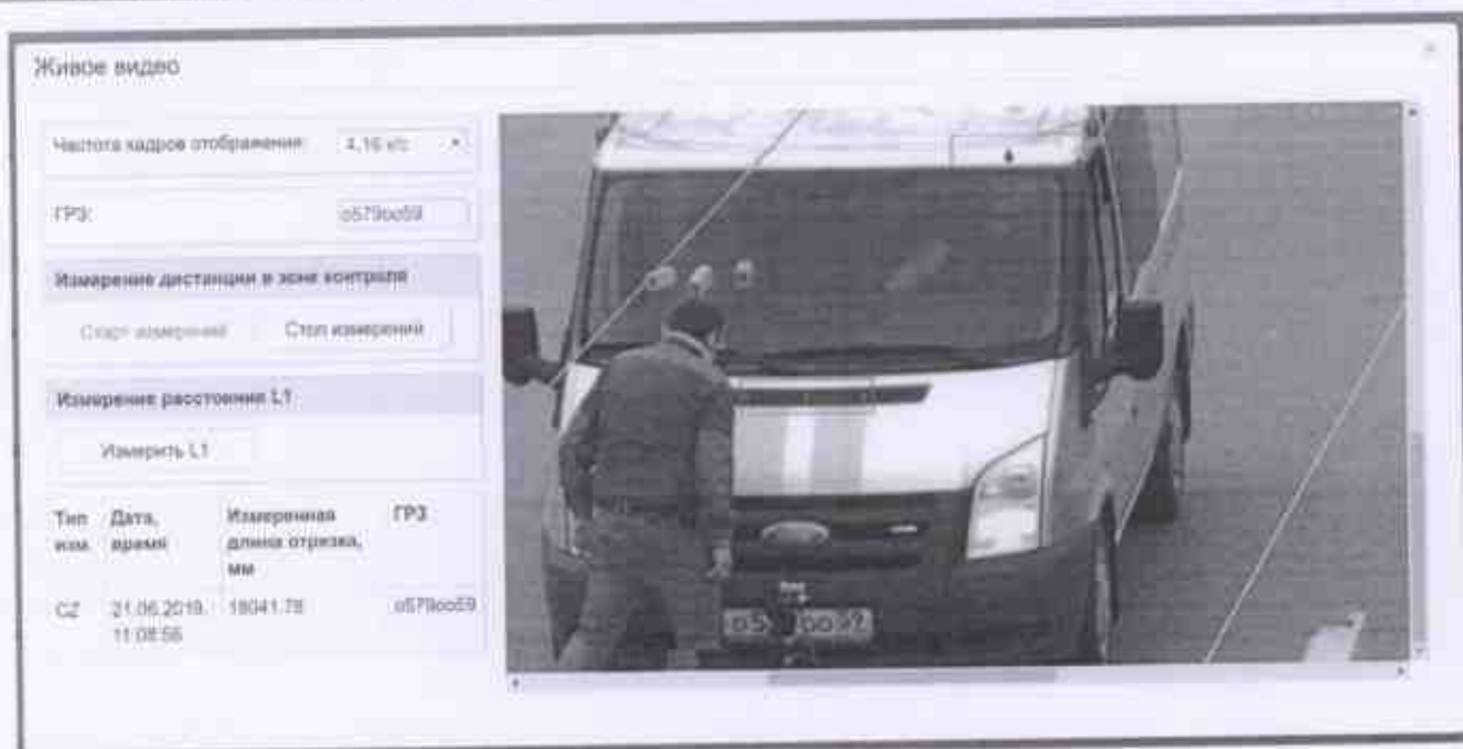
Рисунок 6 – Установка лазерного дальномера к ГРЗ
