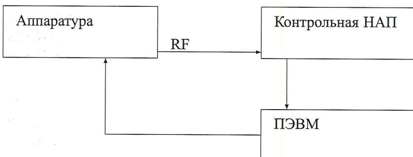
Контрольная НАП - эталонный приёмник навигационного сигнала (рабочий эталон единиц координат местоположения 1 разряда по ГОСТ Р 8.750-2011)
