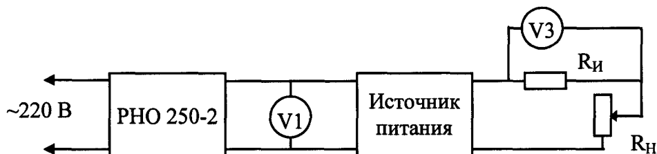
Рис. 4. Структурная схема измерения пульсации выходного тока в режиме стабилизации тока.
