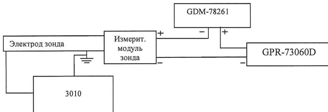
GDM-78261 – вольтметр универсальный (далее – вольтметр), в режиме измерения постоянного тока, мА;
