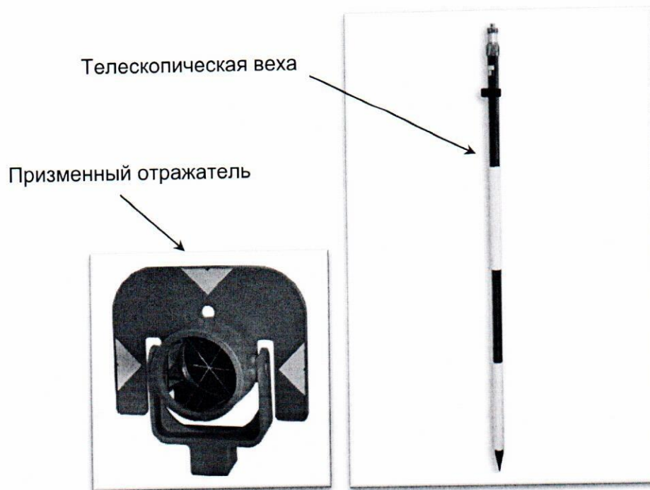
Рисунок А.1 – Веха телескопическая с призмным отражателем
