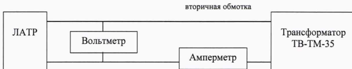
Рисунок 3 – Схема размагничивания по 3-му методу
