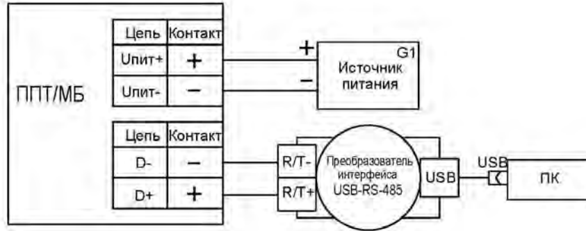
Рисунок 2.20 – Схема подключения ППТ/МБ к источнику питания G1, преобразователю интерфейса USB-RS485 и ПК
