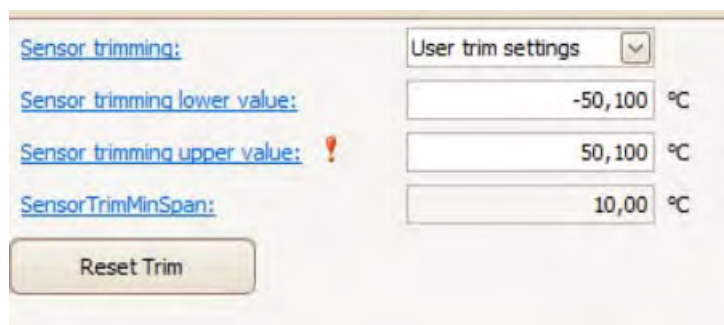
Рисунок Л.1.10 – Окно онлайн-параметрирования ППТ/ХТ-Е, вкладка «Sensor trimming»
