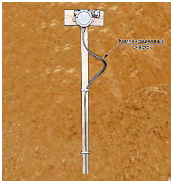
Рисунок 2.9 – Правильное положение головок типа «Г6», «Г7», «Г6М», «Г7М», «Г6Н», «Г7Н» с кабелем на основе гибкого рукава в оплетке на месте их установки
