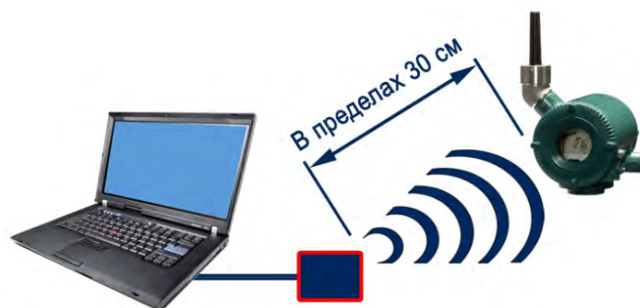
Рисунок Н.2 – Схема взаимного расположения ППТ/МБ и ИК-адаптера при проведении настройки
