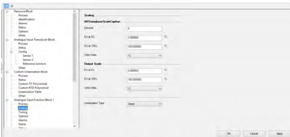
Рисунок И.16 – Окно «Scaling» для установки границ диапазона измерений
