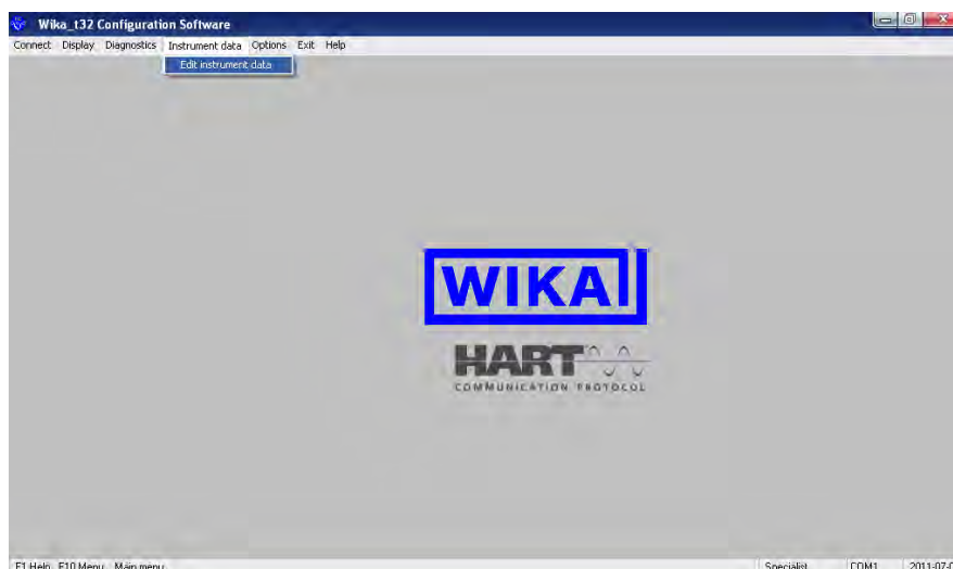
Рисунок Ж.10 – Выбор пункта меню «Edit instrument data» в главном окне программы
