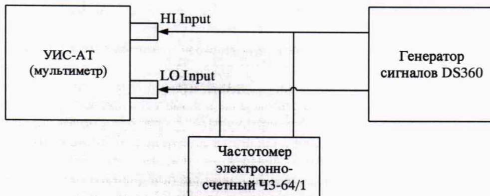
Рисунок 8 – Структурная схема соединения приборов при проверке погрешности измерений частоты
