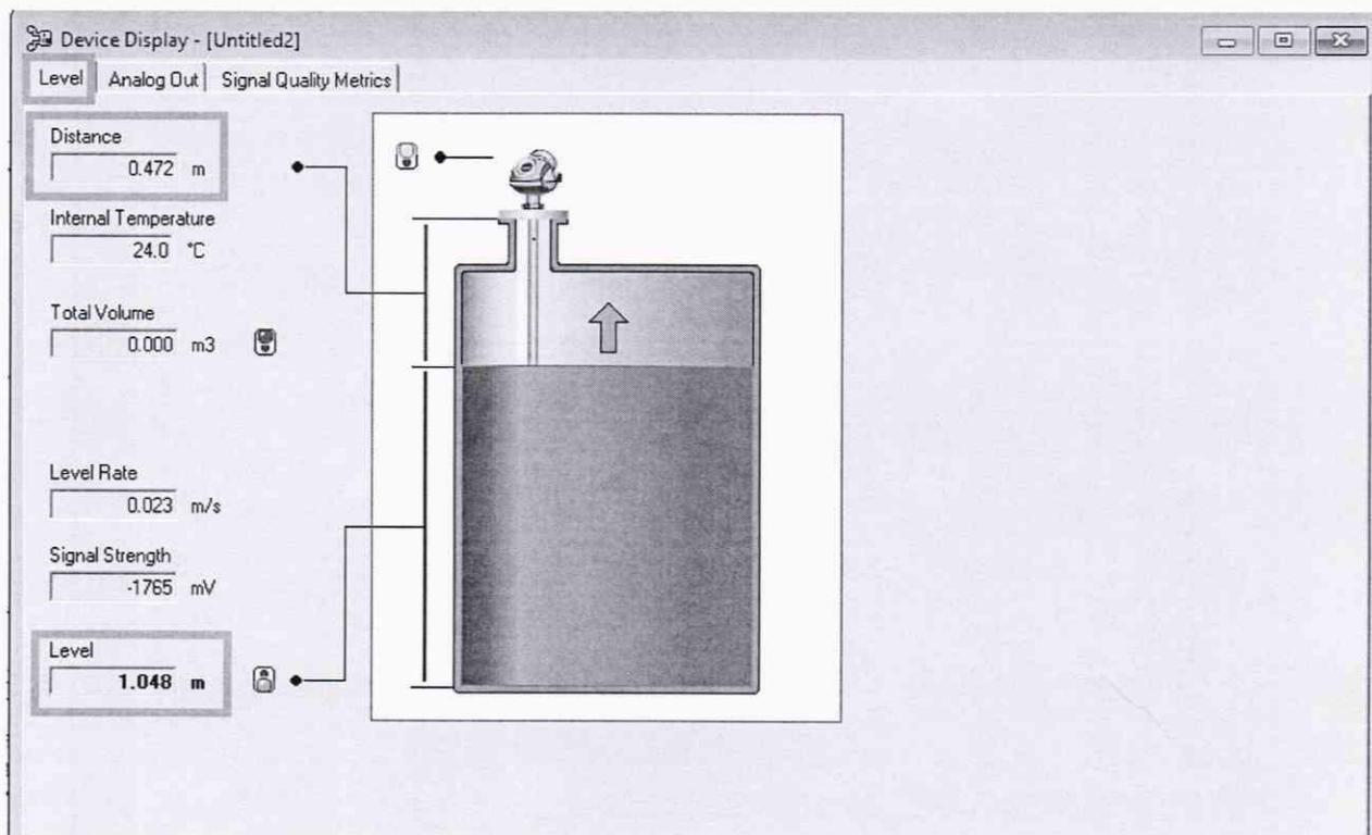
Сравнивают измеренное расстояние до реперного отражателя с записью в паспорте, сделанной при установке уровнемера.
