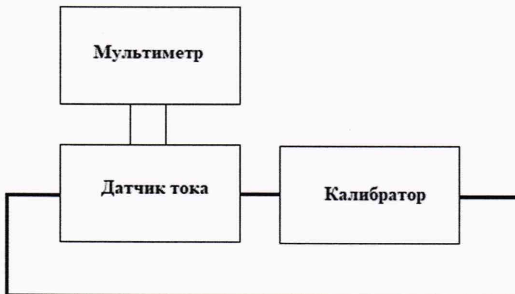
Рисунок 1 – Структурная схема определения приведенной (к верхнему значению диапазона входных значений силы переменного тока) погрешности преобразований силы переменного тока
