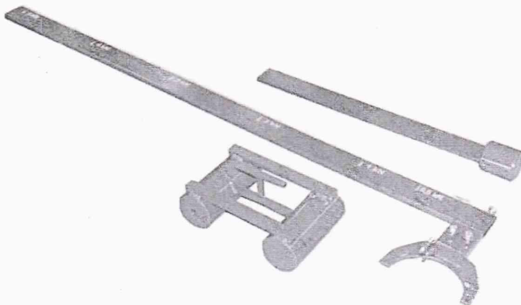
Рисунок А.1 - Внешний вид калибровочного рычага и калибровочного груза для стандов серий МВТ 1000, МВТ 2000
