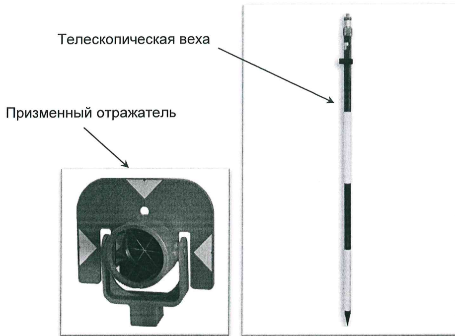
Рисунок А.1 – Веха телескопическая с призмным отражателем
