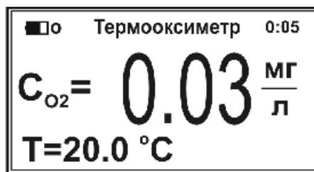
**ВНИМАНИЕ!** В процессе измерения концентрации кислорода функция коррекции градуировочного графика должна быть отключена. Если в правом верхнем углу дисплея
