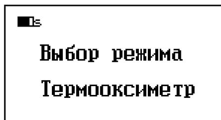
В левом верхнем углу дисплея отобразится символ состояния аккумулятора. В нижней строке отобразится название текущего режима «Термооксиметр».
