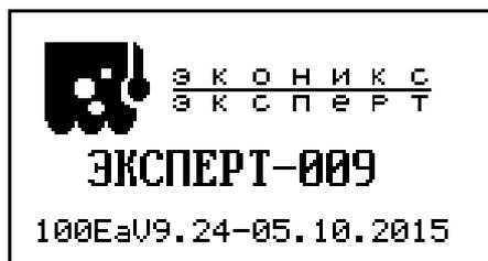
На дисплее отобразятся логотип и наименование фирмы-изготовителя «Эконикс-Эксперт», наименование прибора «Эксперт-009» и шифр версии программного обеспечения (например, «100EaV9.24-05.10.2015»), не являющегося метрологически значимым. Примерно через 3 - 5 секунд на дисплее отобразится информация о степени заряда аккумулятора:
