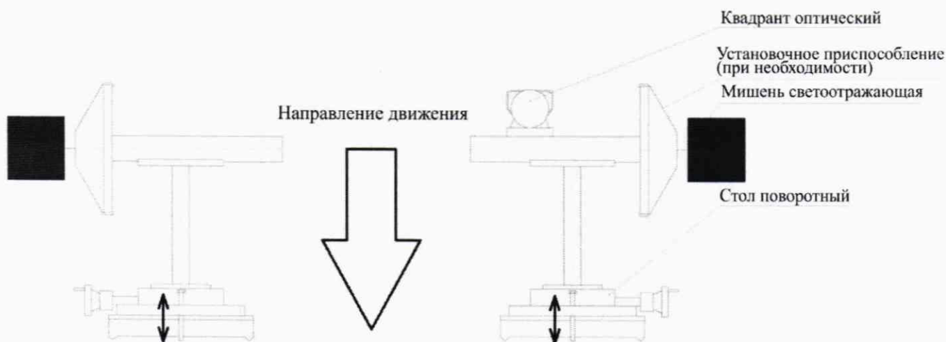
Рисунок А.3 – Схема измерений углов продольного наклона оси поворота колес
