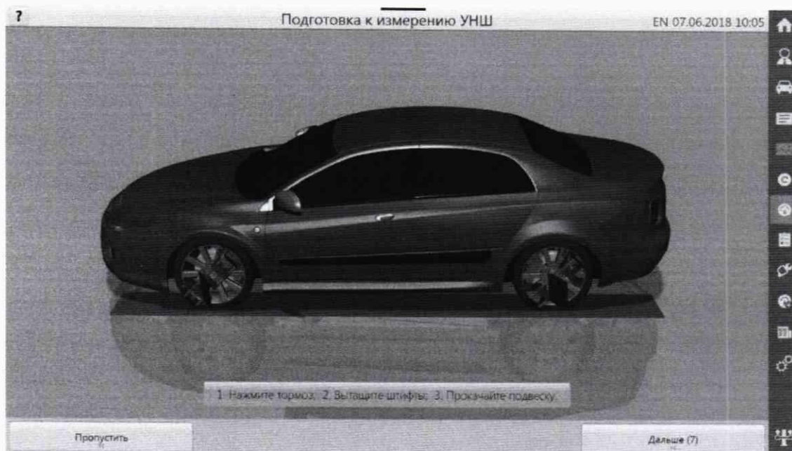
Рисунок Б.7 – Окно подготовки к измерениям углов продольного и поперечного наклонов оси поворота колес
