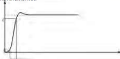
Рис. 6. Изображение испытательного импульса при измерении времени нарастания переходной характеристики t_n
