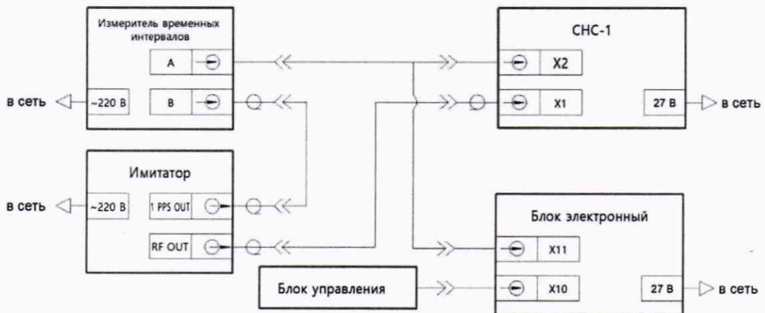
Рисунок 6 — Схема подключения наземной части ИИС-32М для определения координат местоположения базовой станции
