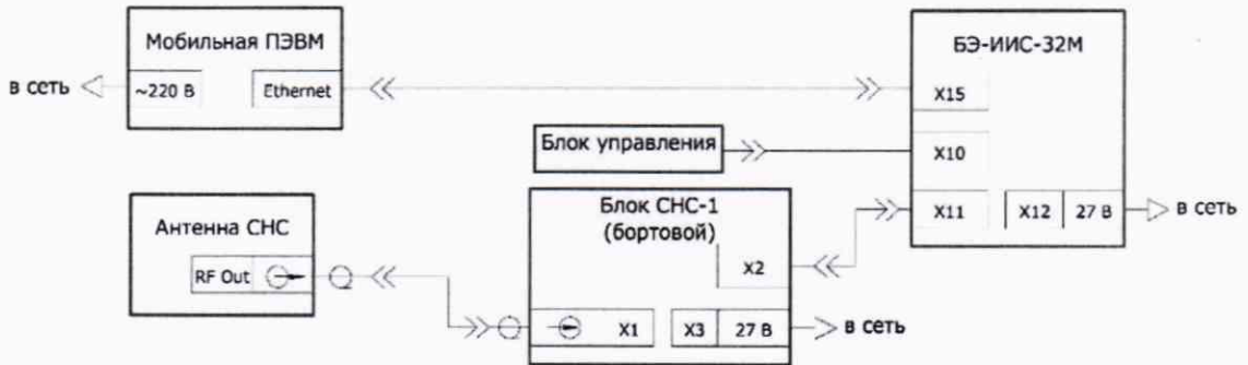
Рисунок 5— Схема подключения ИИС-32М для определения координат местоположения в режиме PPP
