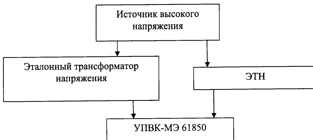
Рисунок 2 - Схема для проверки допускаемой относительной погрешности напряжения переменного тока и допускаемой абсолютной погрешности преобразования угла фазового сдвига (для выхода 61850)
