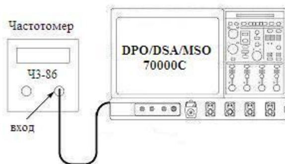
Рисунок 4- Схема определения погрешности частоты опорного генератора
