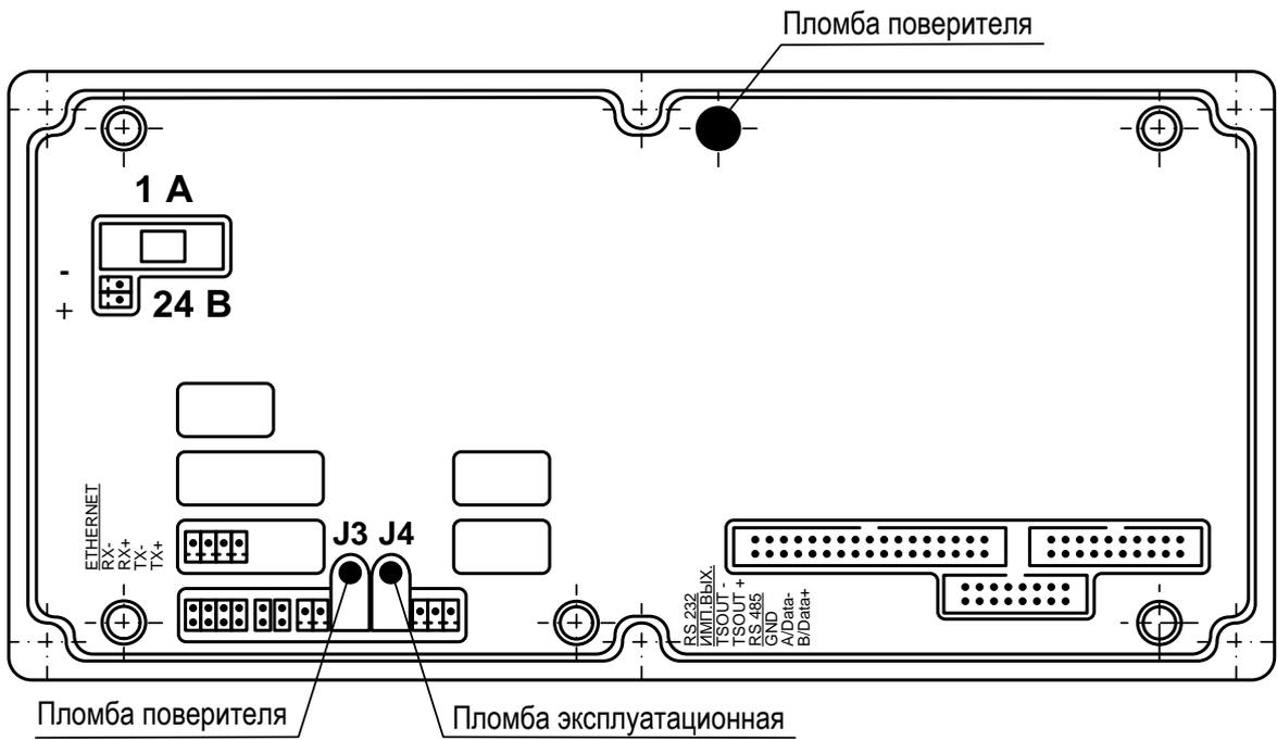
**Рис.А.4. Места пломбирования субблока обработки данных.**
