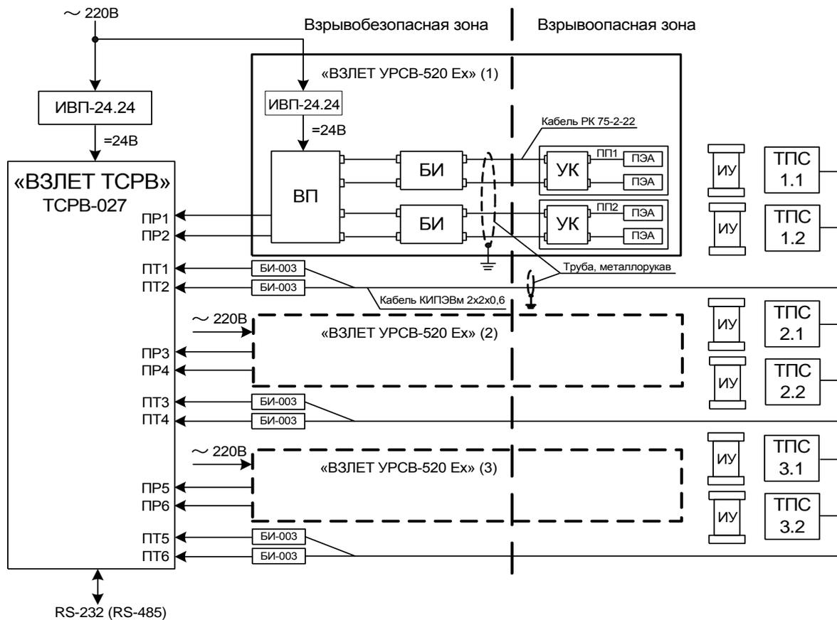
БИ – блок искрозащитный; БИ-003 – барьер искробезопасности ООО «НПК Ленпромавтоматика»; ВП – вторичный преобразователь; ИУ – измерительный участок; ПП1,2 – первичный преобразователь; ПЭА – преобразователь электроакустический; ТПС – термопреобразователь сопротивления; УК – устройство коммутационное.
