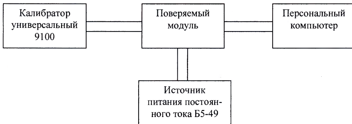
Рисунок 1 – Структурная схема для определения нормируемых метрологических характеристик и для проведения опробования
