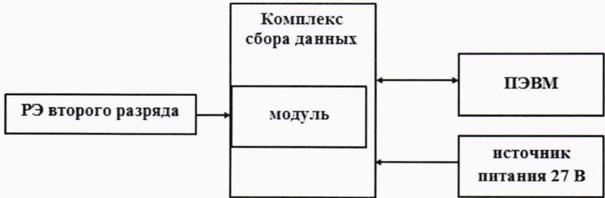
Рисунок 1 - Схема для проведения измерений при проверке опробования
