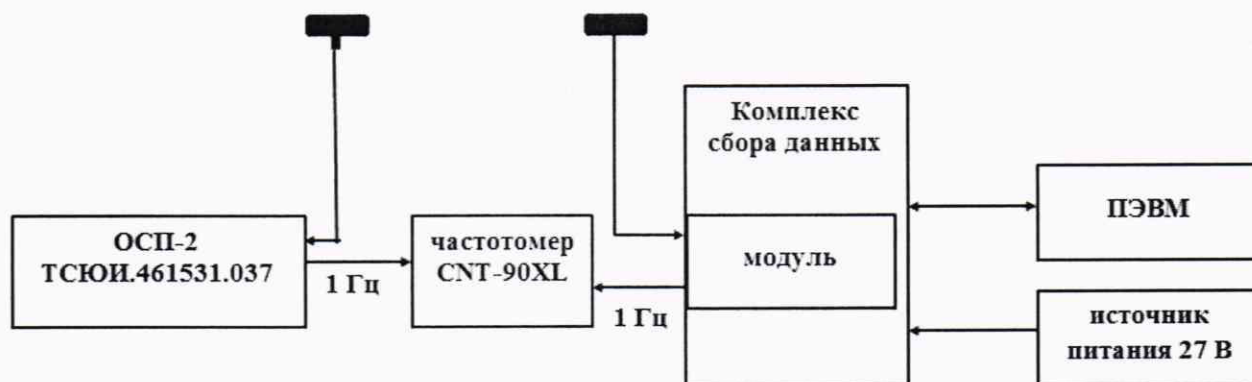
Рисунок 3 – Схема для проведения измерений при определении абсолютной погрешности синхронизации внутренней шкалы времени модуля с национальной шкалой координированного времени UTC(SU)
