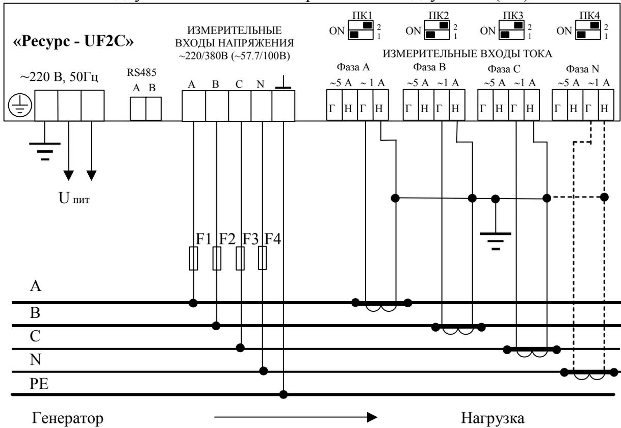
Рисунок К.3 - Трехфазная пятипроводная схема измерения напряжения (220/380В) и схема измерения тока с тремя (или четырьмя) ТТ (1А)
