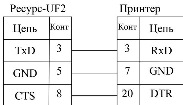
Рисунок Ж.11 Схема подключения измерителей к принтеру фирмы EPSON с использованием сигнала готовности приемника
