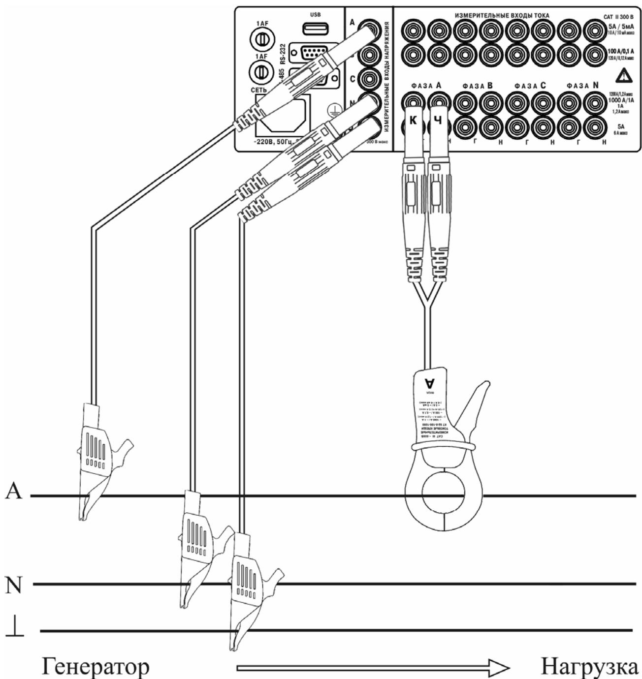
Рисунок Р.5 – Схема подключений измерителя «Ресурс-UF2М» для измерений в однофазной трехпроводной системе с помощью токоизмерительных клещей КТ52-5-100-1000 на пределе 1000 А
