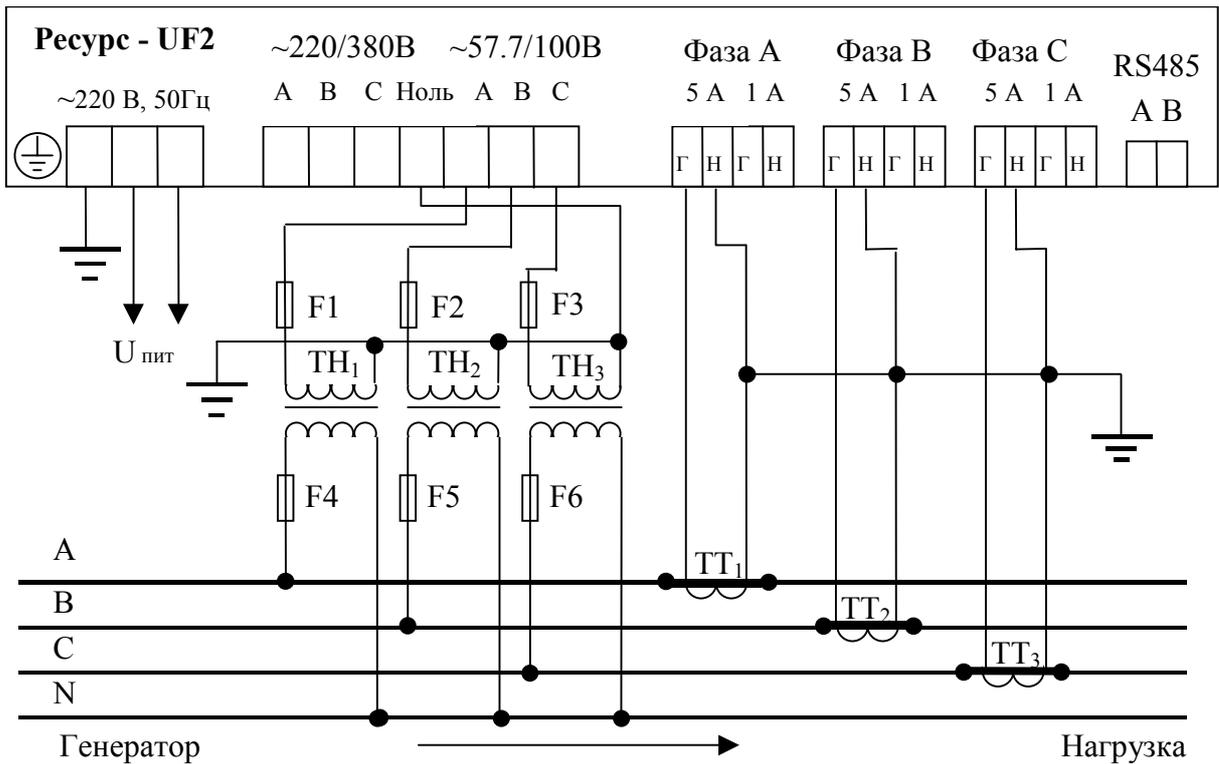
Рисунок И.1 - Трехфазная четырехпроводная схема измерения напряжения с тремя ТН и схема измерения тока с тремя ТТ (5А)
