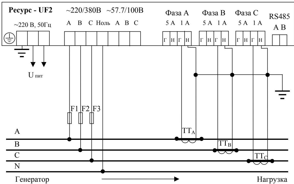
Рисунок И.3 - Трехфазная четырехпроводная схема измерения напряжения (220/380В) и схема измерения тока с тремя ТТ (1А)
