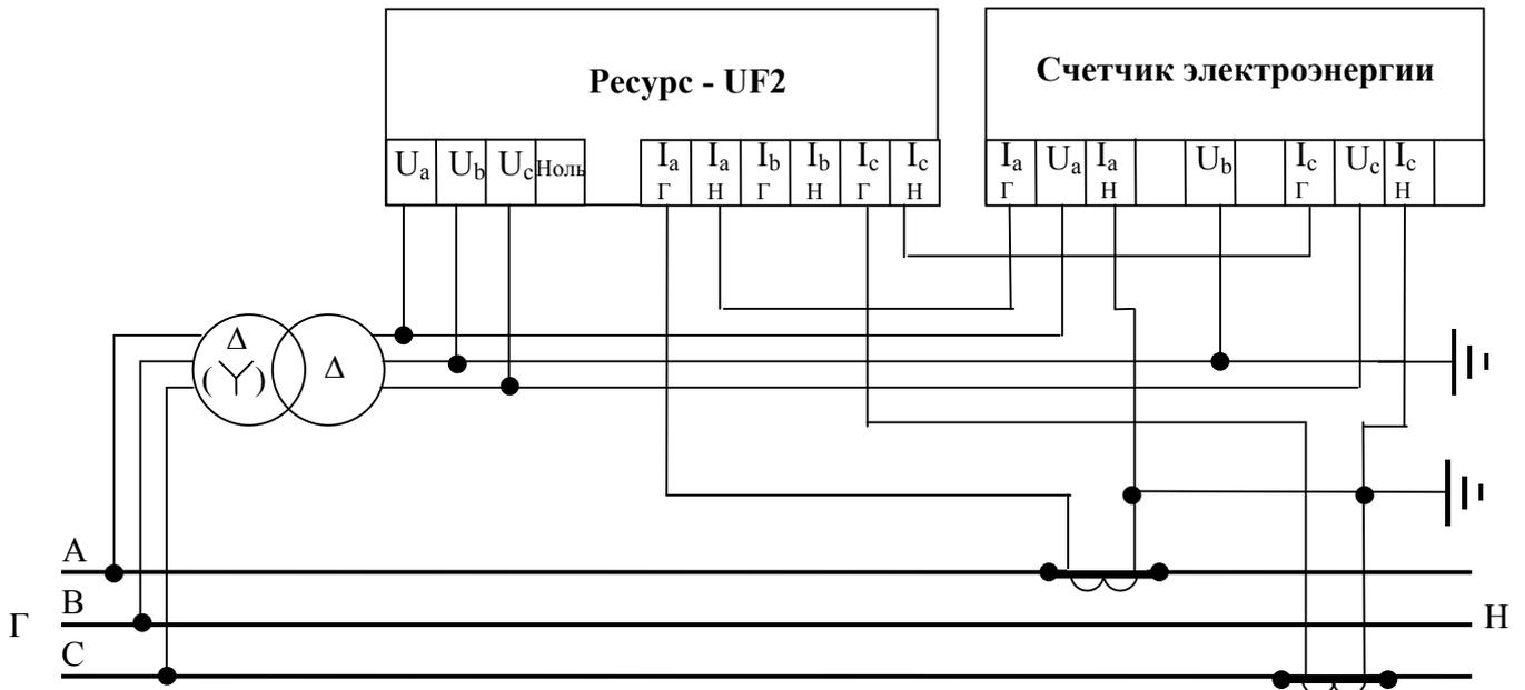
Рисунок Л.2 - Схема совместного подключения измерителя и счетчика электроэнергии (с двумя токовыми входами) к двум ТН (трехфазная трехпроводная измерительная схема) и двум ТТ.
