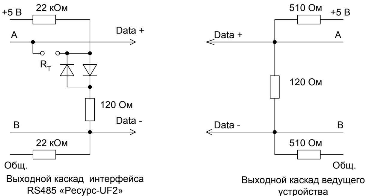
В модификациях «Ресурс-UF2М» переключатель  $R_T$  установлен.
