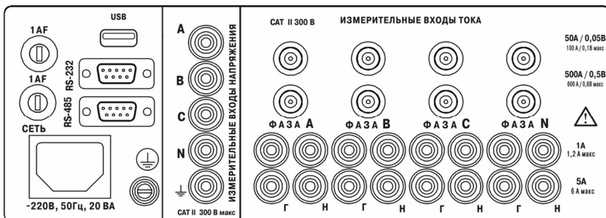
Рисунок П.3 - Задняя панель измерителей
