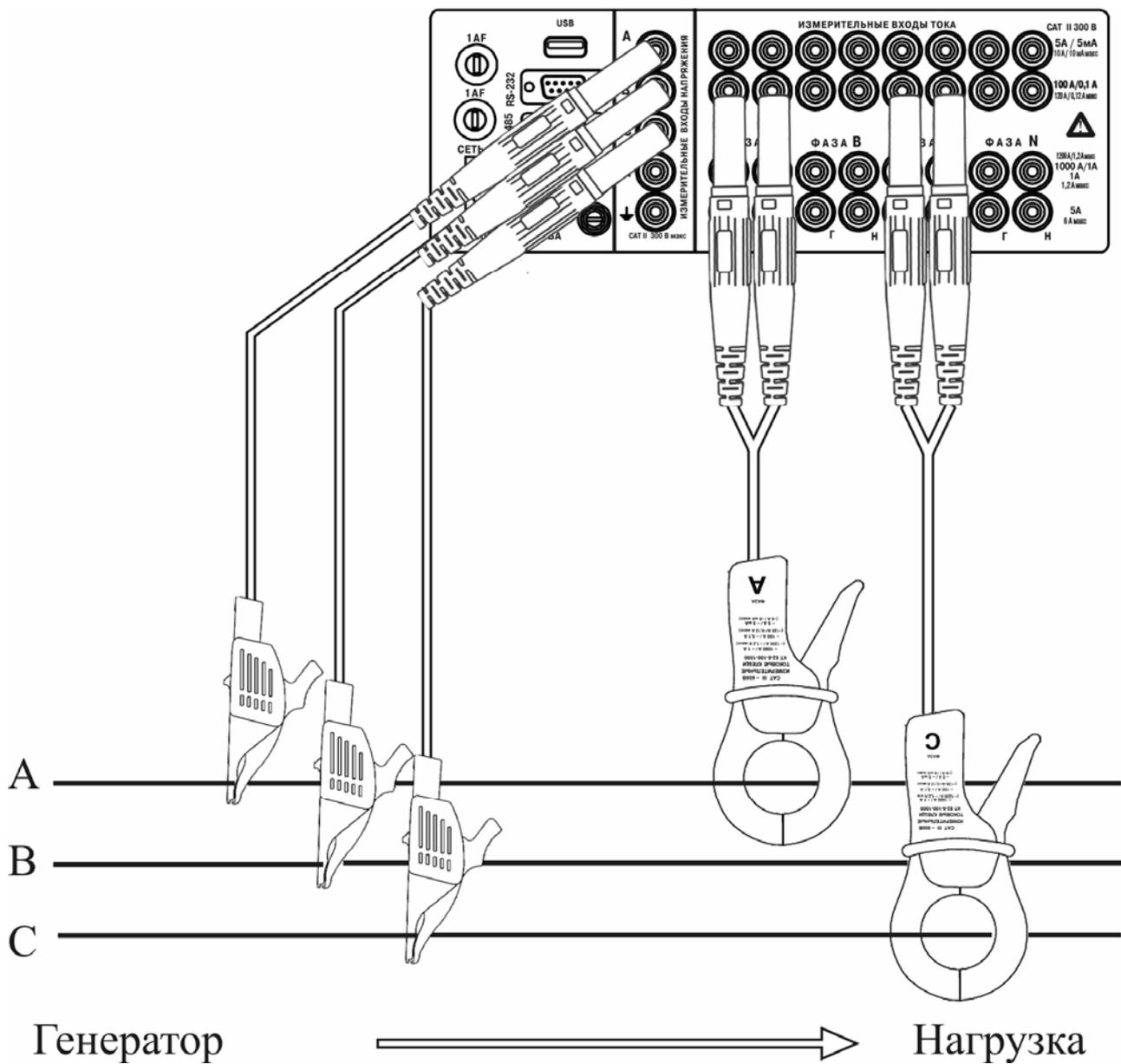
Рисунок Р.3 – Схема подключений измерителя «Ресурс-UF2М-3Т52-5-100-1000» для измерения в трехфазной трехпроводной системе с помощью токоизмерительных клещей КТ52-5-100-1000 на пределе 100 А
