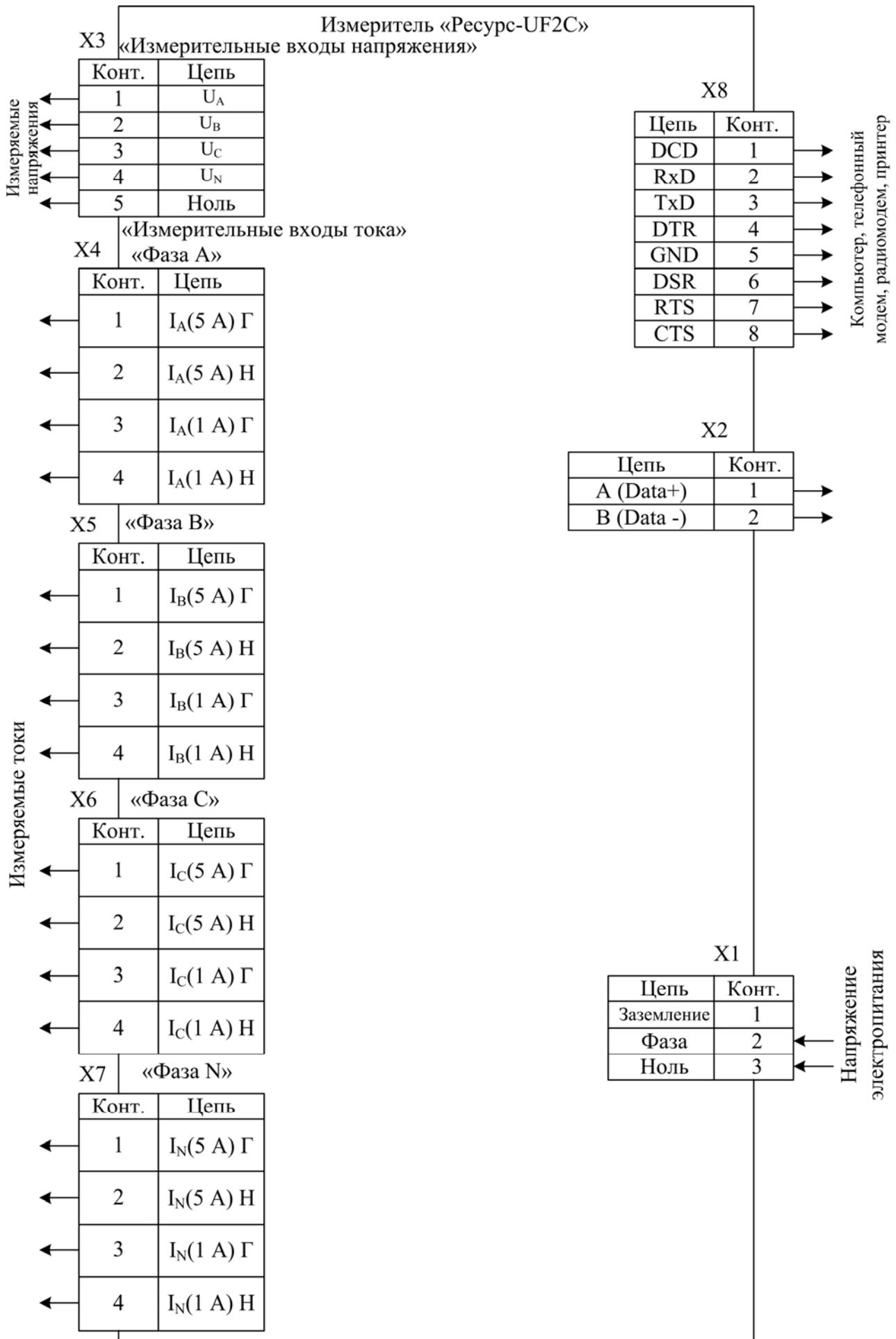
Рисунок Ж.4 - Назначение контактов разъемов измерителя «Ресурс-UF2С»
