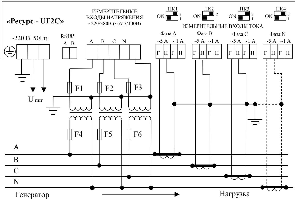
Рисунок К.1 - Трехфазная четырехпроводная схема измерения напряжения с тремя ТН и схема измерения тока с тремя (четырьмя) ТТ (5А)
