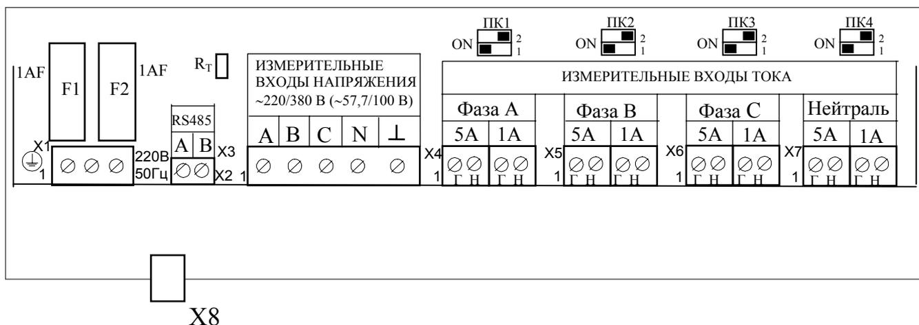
ПК1 – ПК4 – переключатели диапазонов измеряемых токов  $I_a$ ,  $I_b$ ,  $I_c$ ,  $I_n$  (устанавливаются в произвольное положение).
