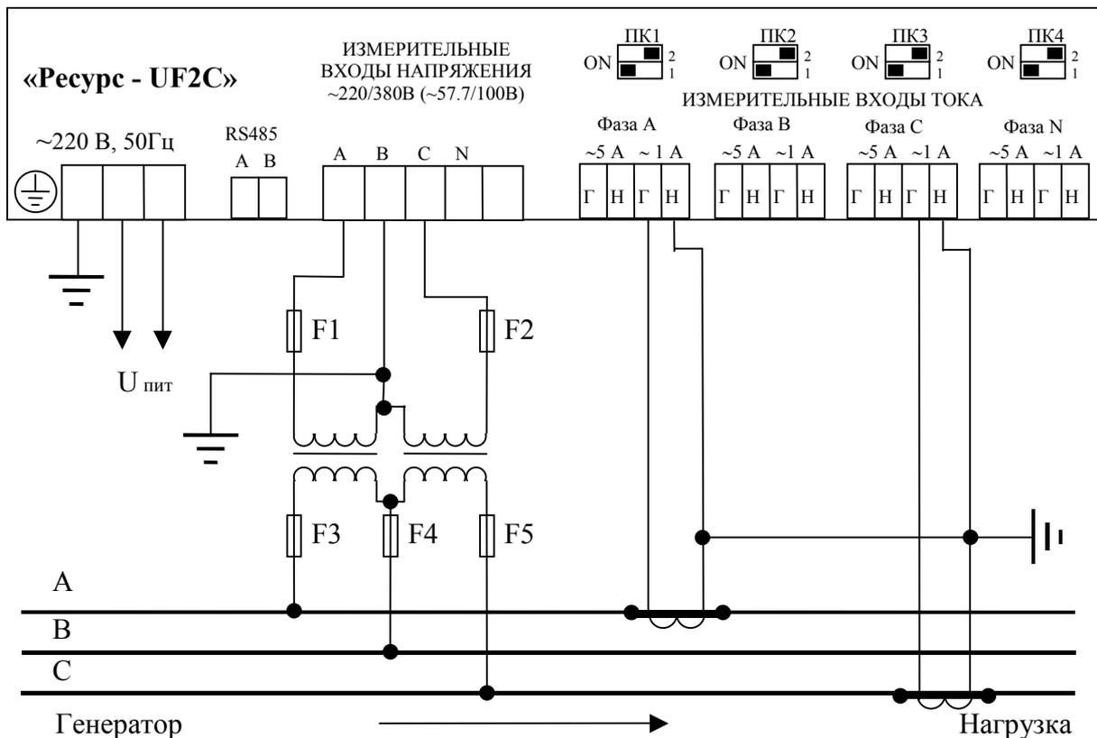
Рисунок К.2 - Трехфазная трехпроводная схема измерения напряжения
