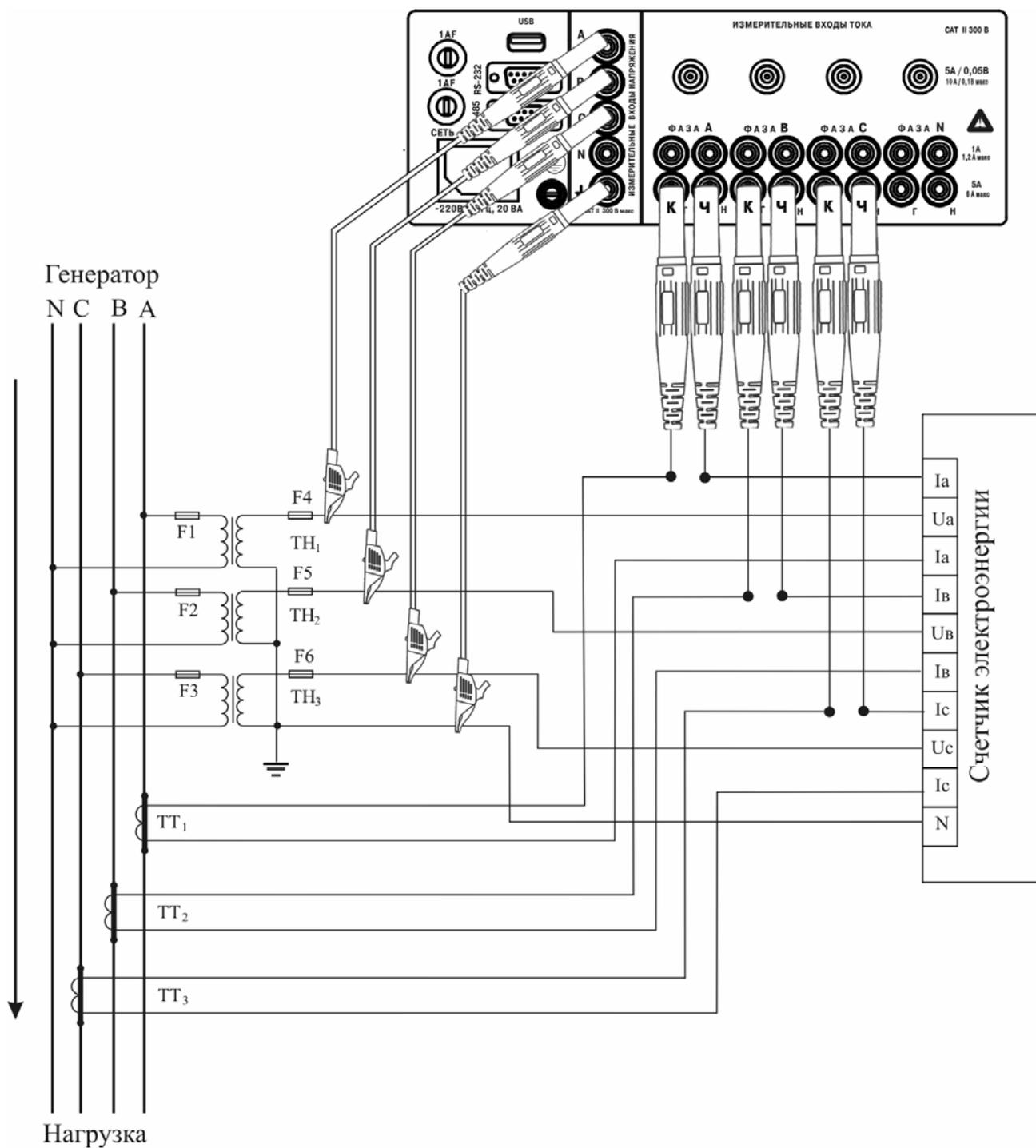
Рисунок Р.8 – Схема подключений к трехфазной четырехпроводной сети с тремя ТН и тремя ТТ счетчика электрической энергии и измерителя «Ресурс-UF2М-3П15-5» в разрыв вторичных цепей ТТ на пределе 5 А
