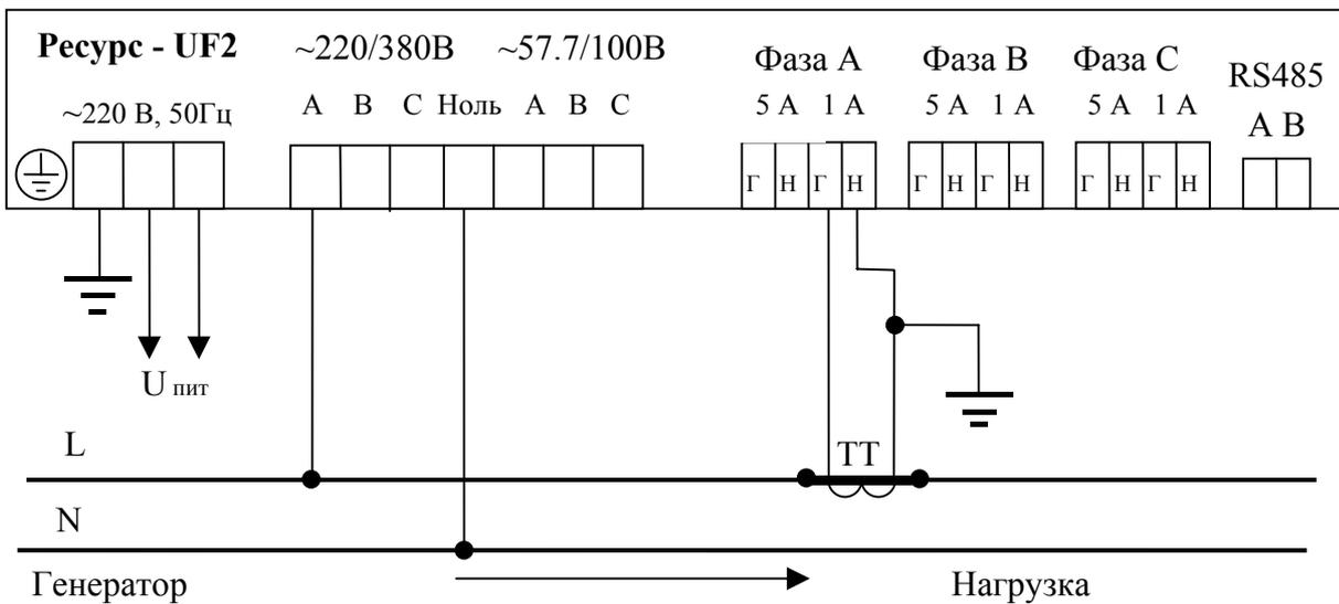
Рисунок И.4 - Однофазная схема измерения с использованием ТТ (1А)
