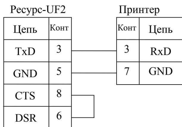
Рисунок Ж.12 - Схема подключения измерителей к принтеру фирмы EPSON без использования сигнала готовности приемника
