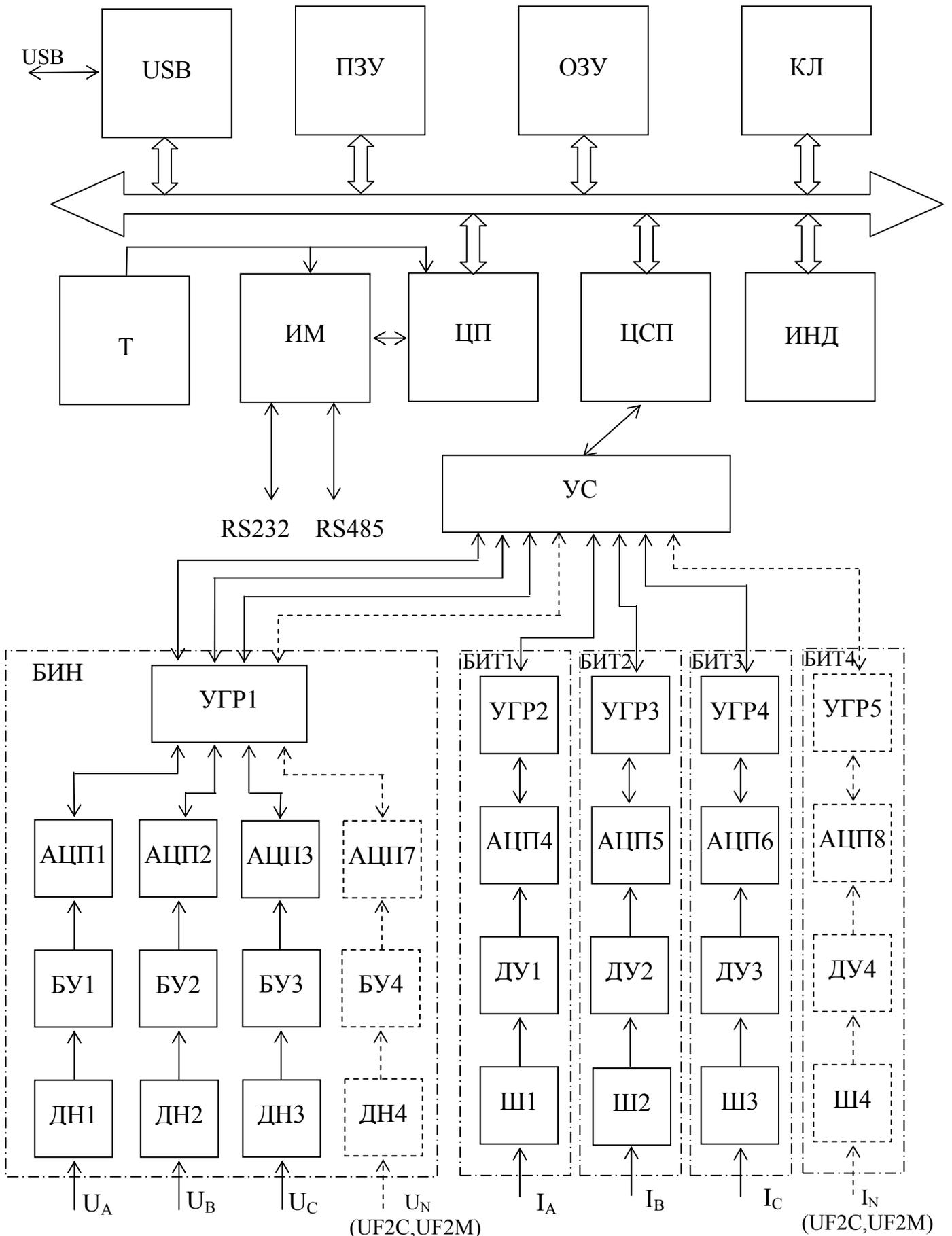
Рисунок Б.1 - Структурная схема измерителя
