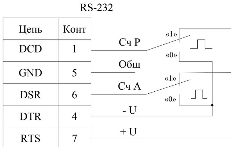
Сч А (сигнал DSR) – импульсный вход от счетчиков активной энергии,
