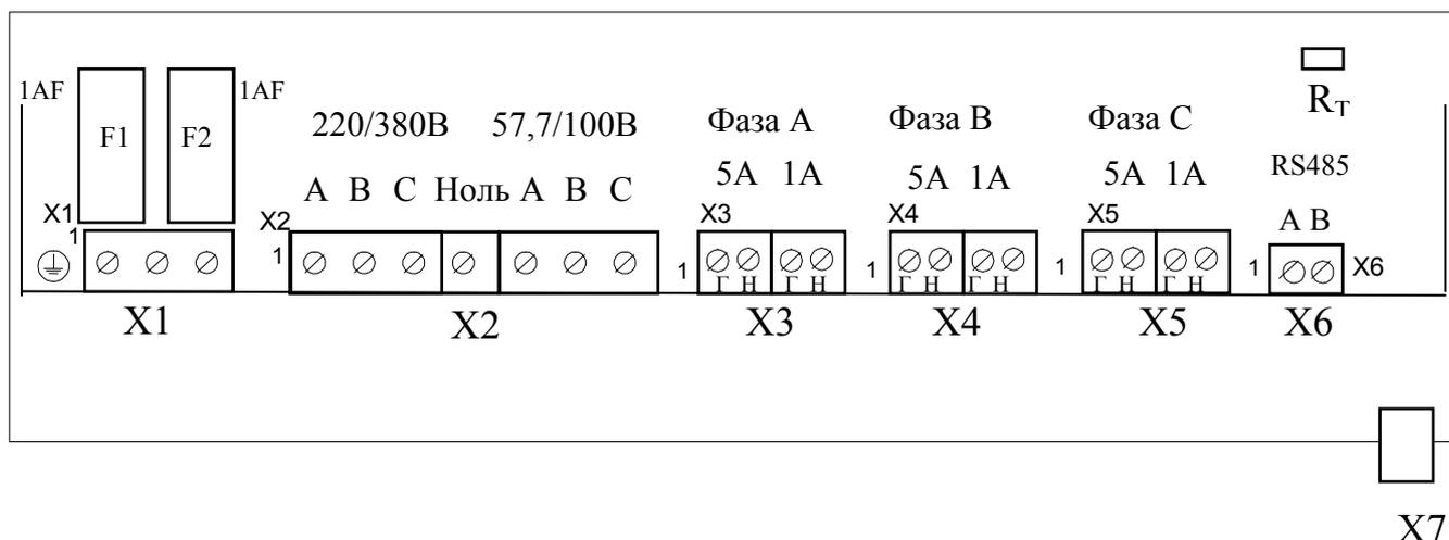
X1 – винтовые клеммные соединители для подключения питающего напряжения (контакт 2 , 3) и защитного заземления (контакт 1).
