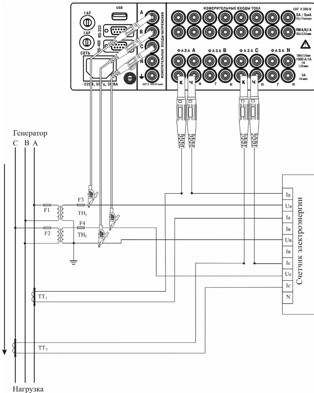
Рисунок Р.9 – Схема подключений к трехфазной трехпроводной сети счетчика электрической энергии и измерителя «Ресурс-UF2М-3Т52-5-100-1000» в разрыв вторичных цепей ТТ на пределе 5 А.
