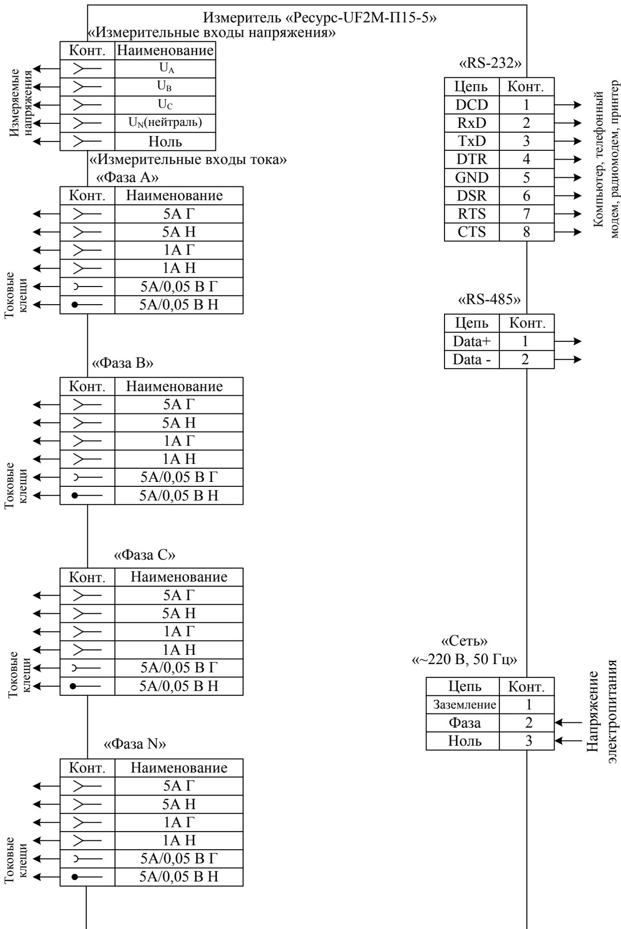
Рисунок Ж.6 – Назначение контактов разъемов измерителя «Ресурс-UF2М-П15-5»
