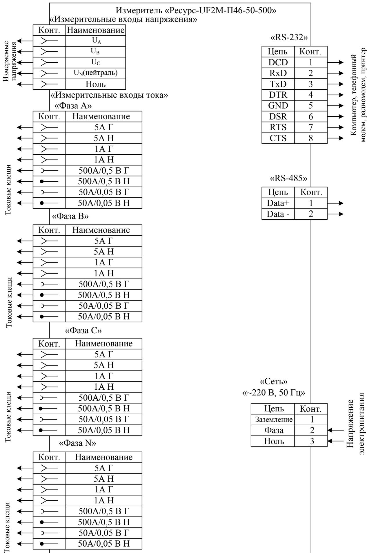
Рисунок Ж.7 – Назначение контактов разъемов измерителя «Ресурс-UF2М-П46-50-500»
