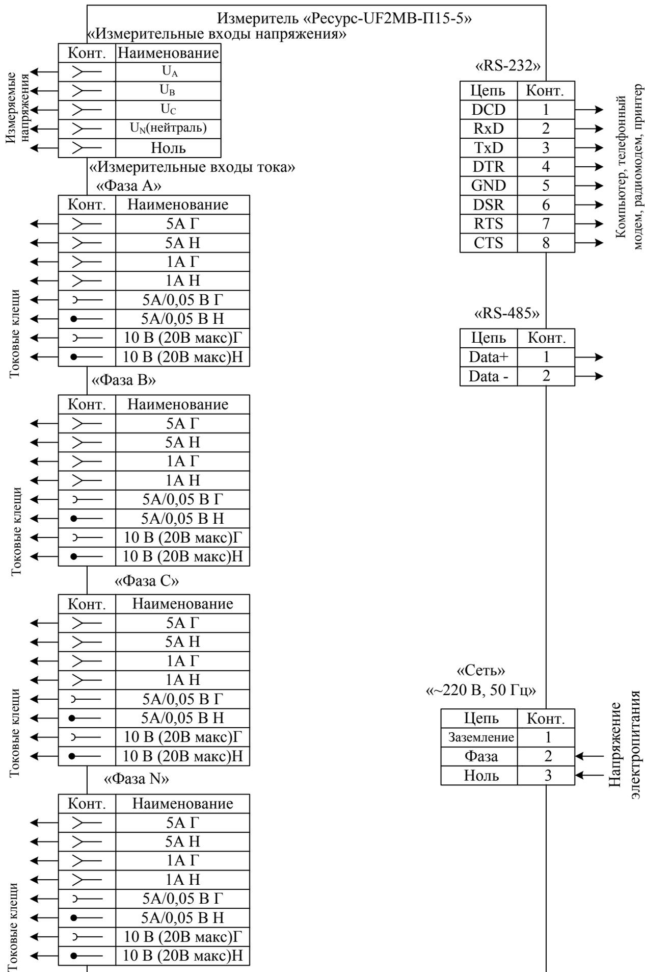
Рисунок Ж.8 – Назначение контактов разъемов измерителя «Ресурс-UF2МВ-П15-5»
