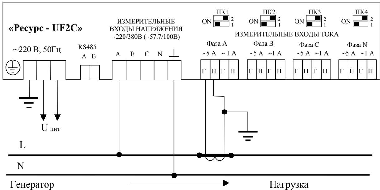
Рисунок К.4 - Однофазная схема измерения без трансформатора напряжения и с трансформатором тока (5А)
