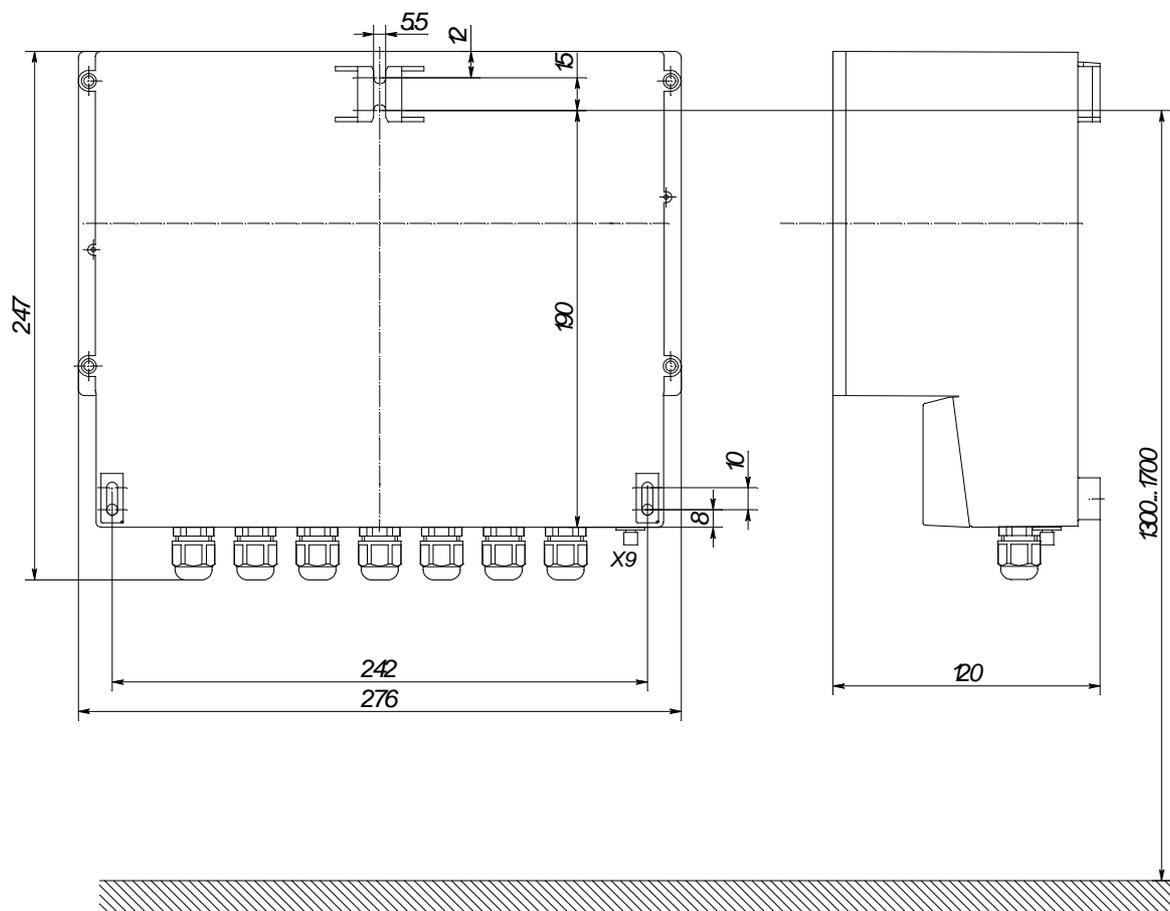
X9 – зажим защитного заземления
