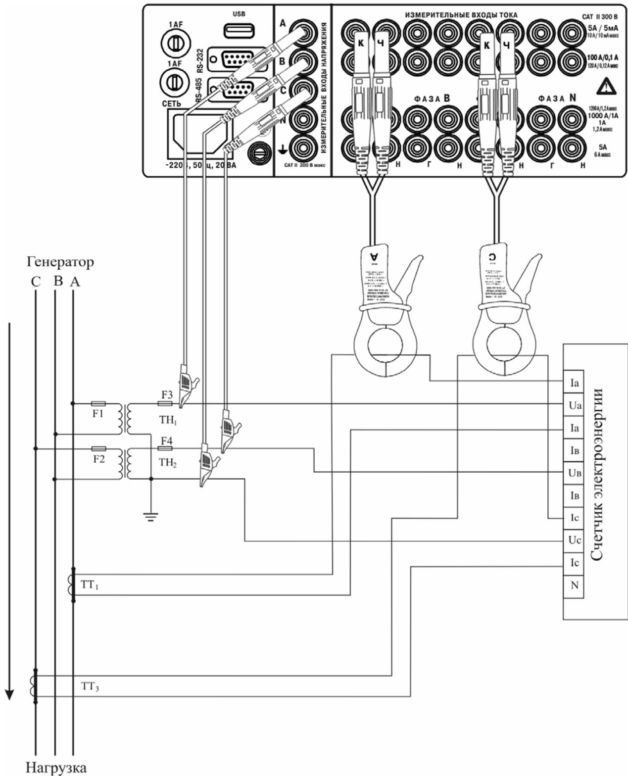
Рисунок Р.7 – Схема подключений к трехфазной трехпроводной сети с двумя ТН и двумя ТТ счетчика электрической энергии и измерителя «Ресурс-UF2М-3Т52-5-100-1000» с использованием двух токоизмерительных клещей КП52-5-100-1000 на пределе 5 А без разрыва вторичной цепи ТТ
