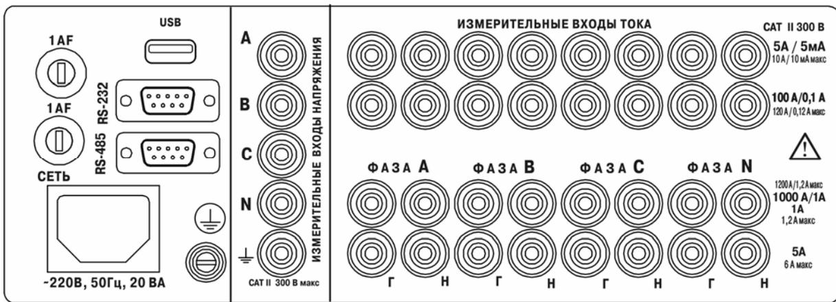
Рисунок П.4 - Задняя панель измерителей «Ресурс-UF2М-3Т52-5-100-1000» и «Ресурс-UF2М-4Т52-5-100-1000»
