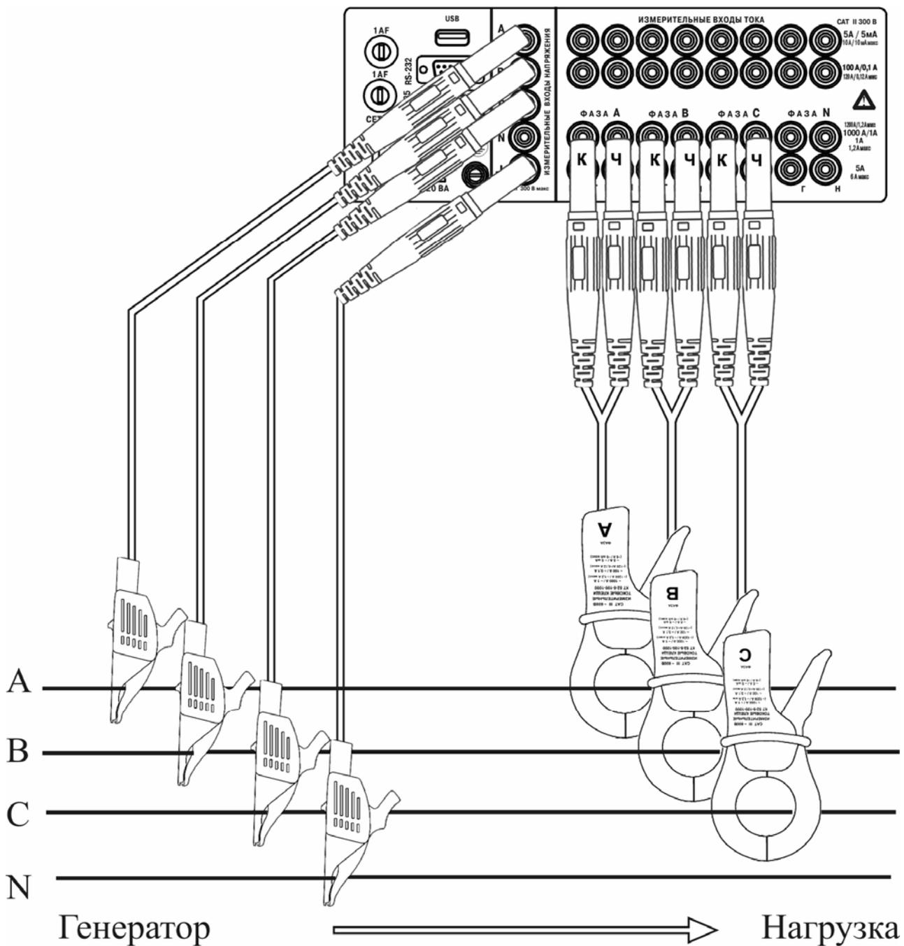
Рисунок Р.2 - Схема подключений измерителя «Ресурс-UF2М-3Т52-5-100-1000» для измерения в трехфазной четырехпроводной системе с помощью токоизмерительных клещей КТ52-5-100-1000 на пределе 1000 А
