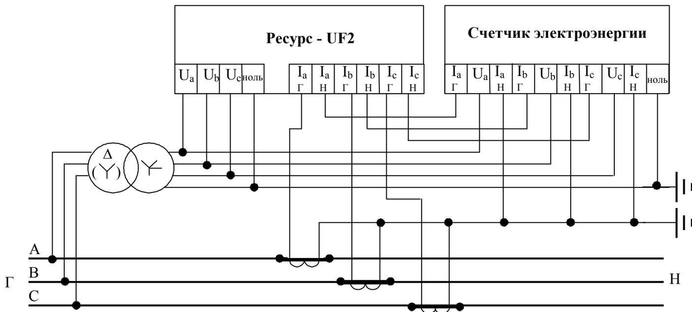
Рисунок Л.1 - Схема совместного подключения измерителя и счетчика электроэнергии к трем ТН и трем ТТ.
