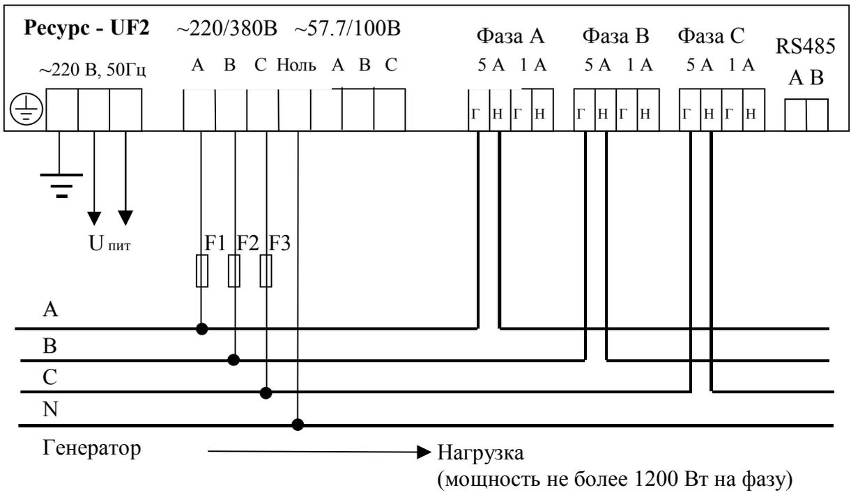
Рисунок И.5 - Трехфазная четырехпроводная схема измерения напряжения (220/380В) и схема прямого измерения тока (5А)
