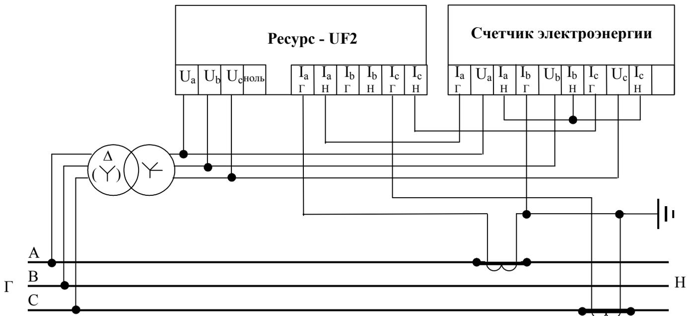
Рисунок Л.3 - Схема совместного подключения измерителя Ресурс-UF2 и счетчика электроэнергии (с тремя токовыми входами) к двум ТН (трехфазная трехпроводная измерительная схема) и двум ТТ.
