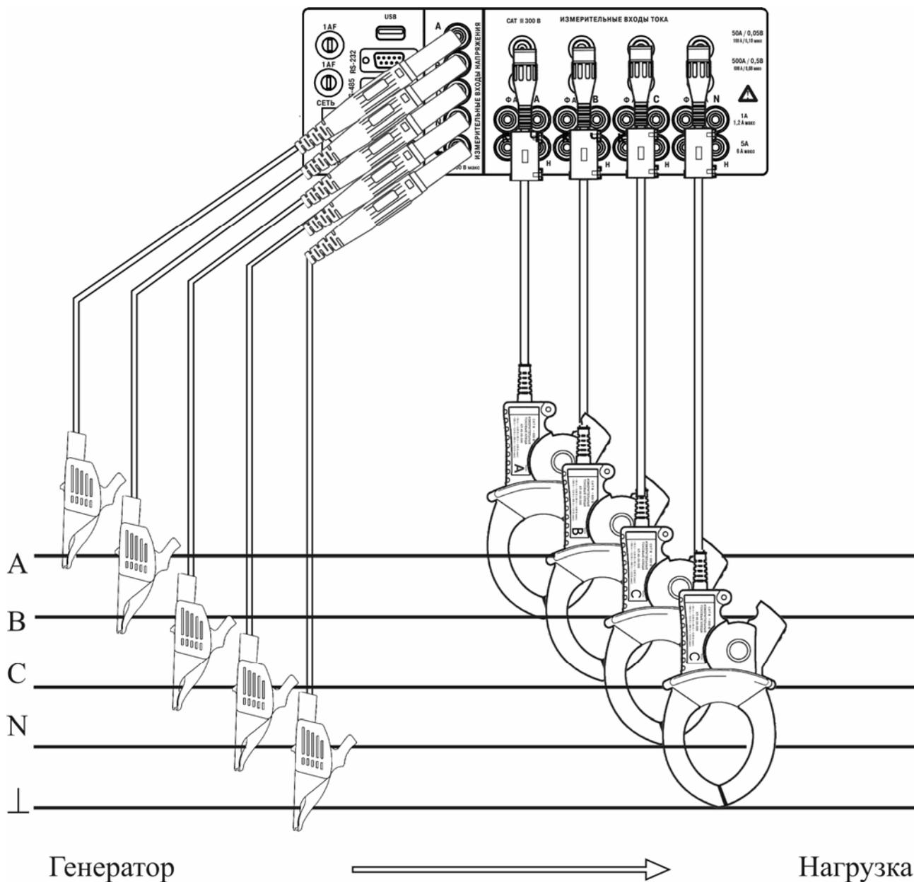
Рисунок Р.1 – Схема подключений измерителя «Ресурс-UF2М-4П46-50-500» для измерения в трехфазной пятипроводной системе с помощью токоизмерительных клещей на пределе измерения 50 А
