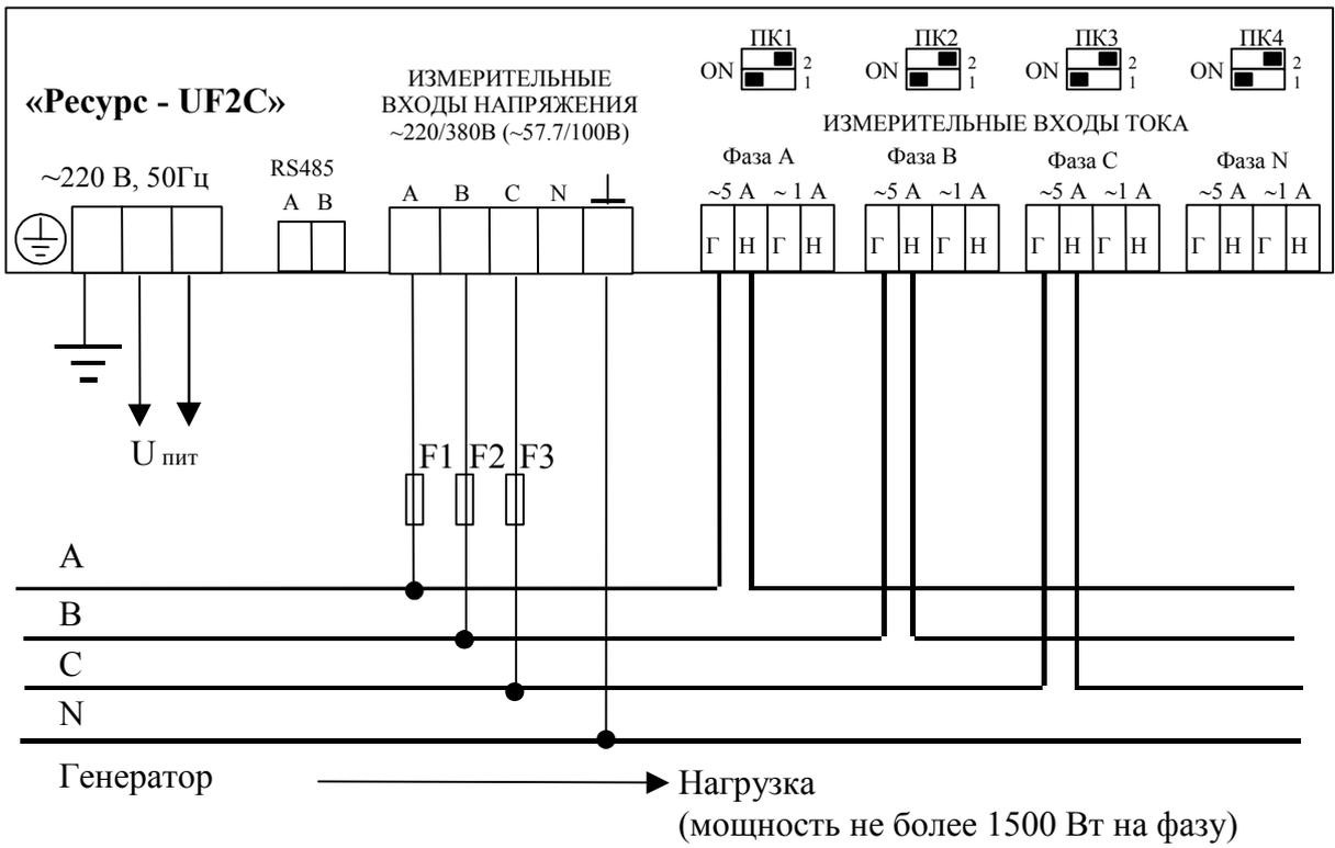
Рисунок К.5 - Трехфазная четырехпроводная схема измерения напряжения (220/380В) и схема прямого измерения тока (5А)
