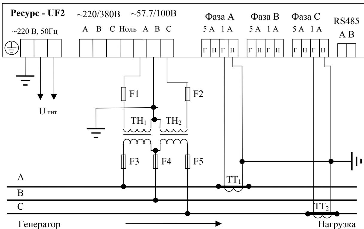
Рисунок И.2 - Трехфазная трехпроводная схема измерения напряжения с двумя ТН и схема измерения тока с двумя ТТ (1А)
