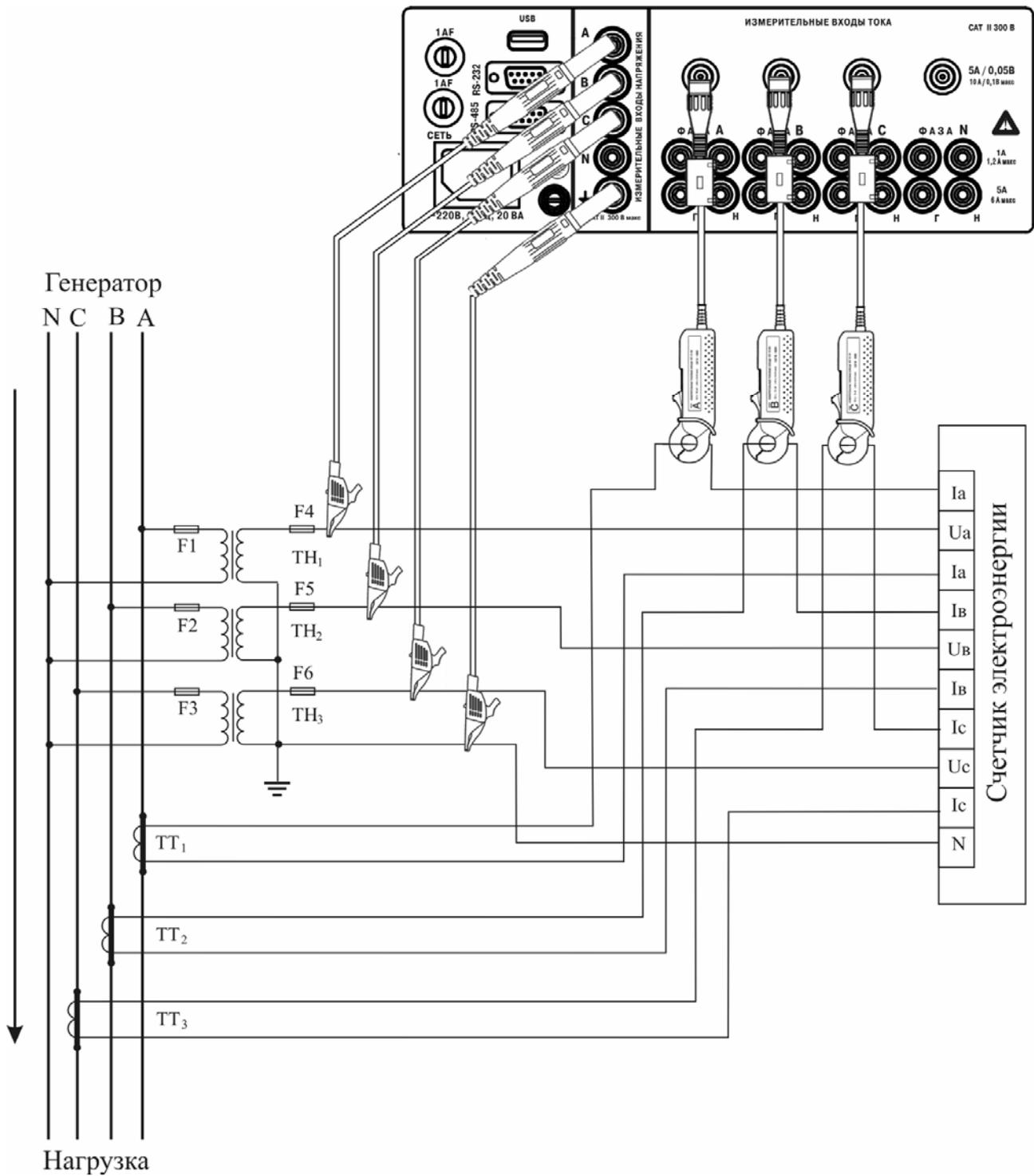
Рисунок Р.6 - Схема подключений к трехфазной четырехпроводной сети с тремя ТН и тремя ТТ счетчика электрической энергии и измерителя «Ресурс-UF2М-3П15-5» с использованием трех токоизмерительных клещей КП15-5 на пределе 5 А без разрыва вторичной цепи ТТ
