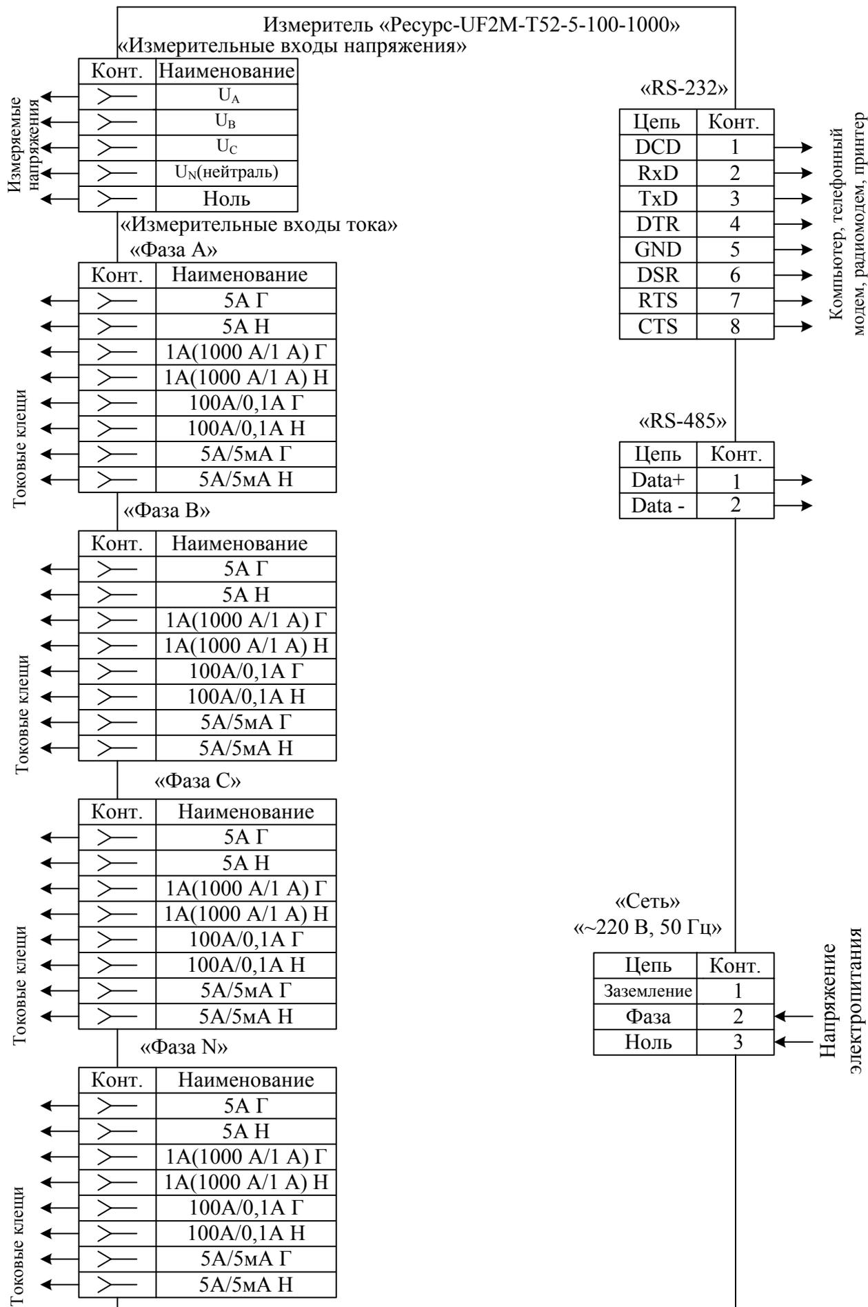
Рисунок Ж.5 – Назначение контактов разъемов измерителя «Ресурс-UF2М-Т52-5-100-1000»
