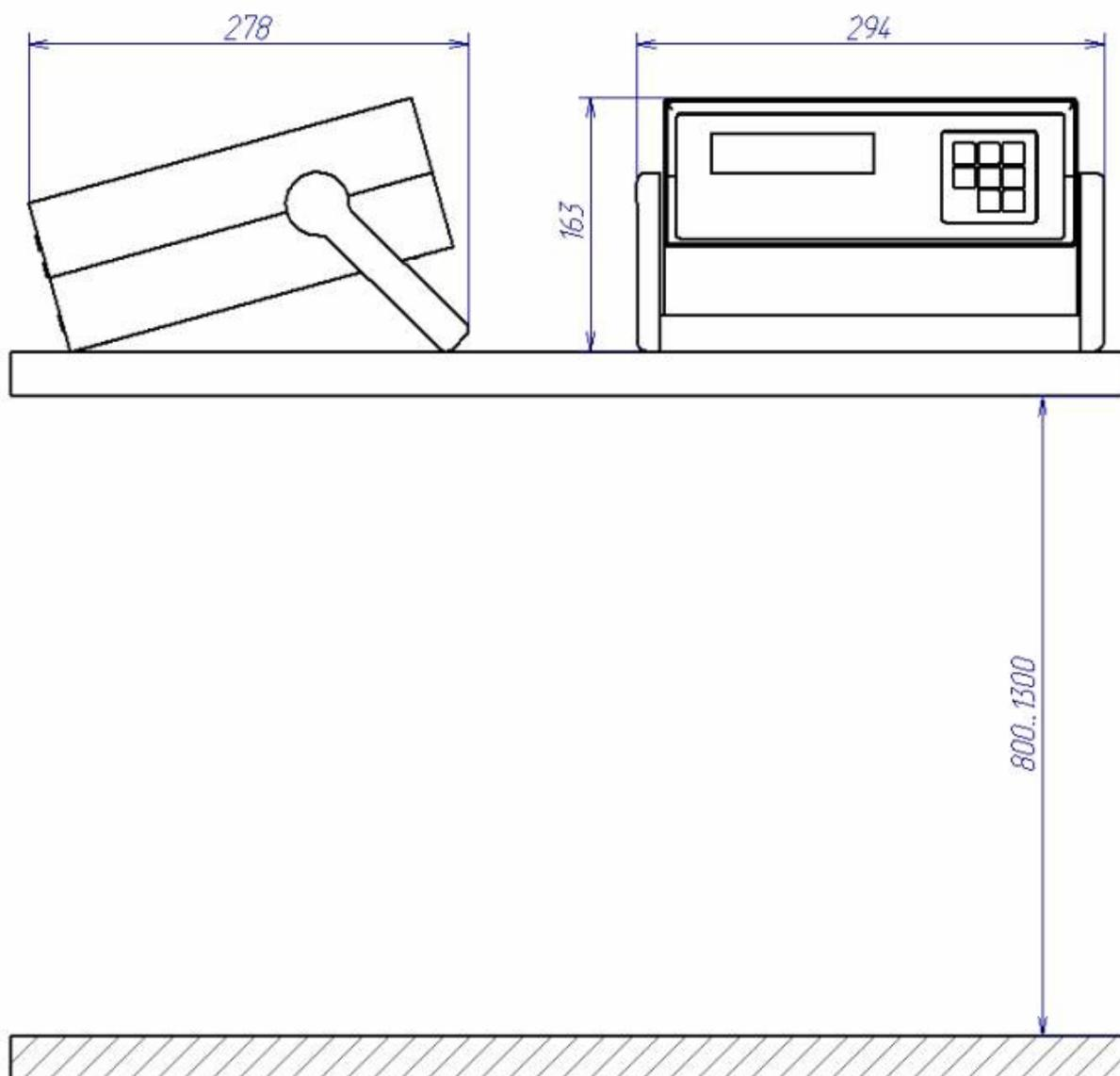
Рисунок Д.2 - Габаритные и установочные размеры измерителя «Ресурс-UF2М»
