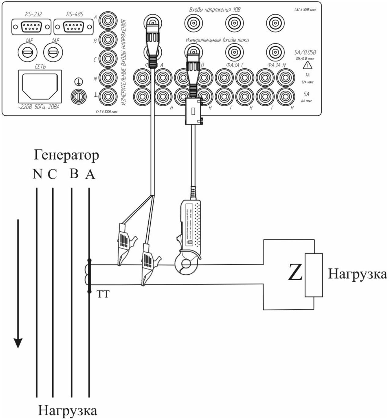
Рисунок С.1 - Схема подключений измерителя Ресурс-UF2MB-KP15-5 при определении нагрузки ТТ.
