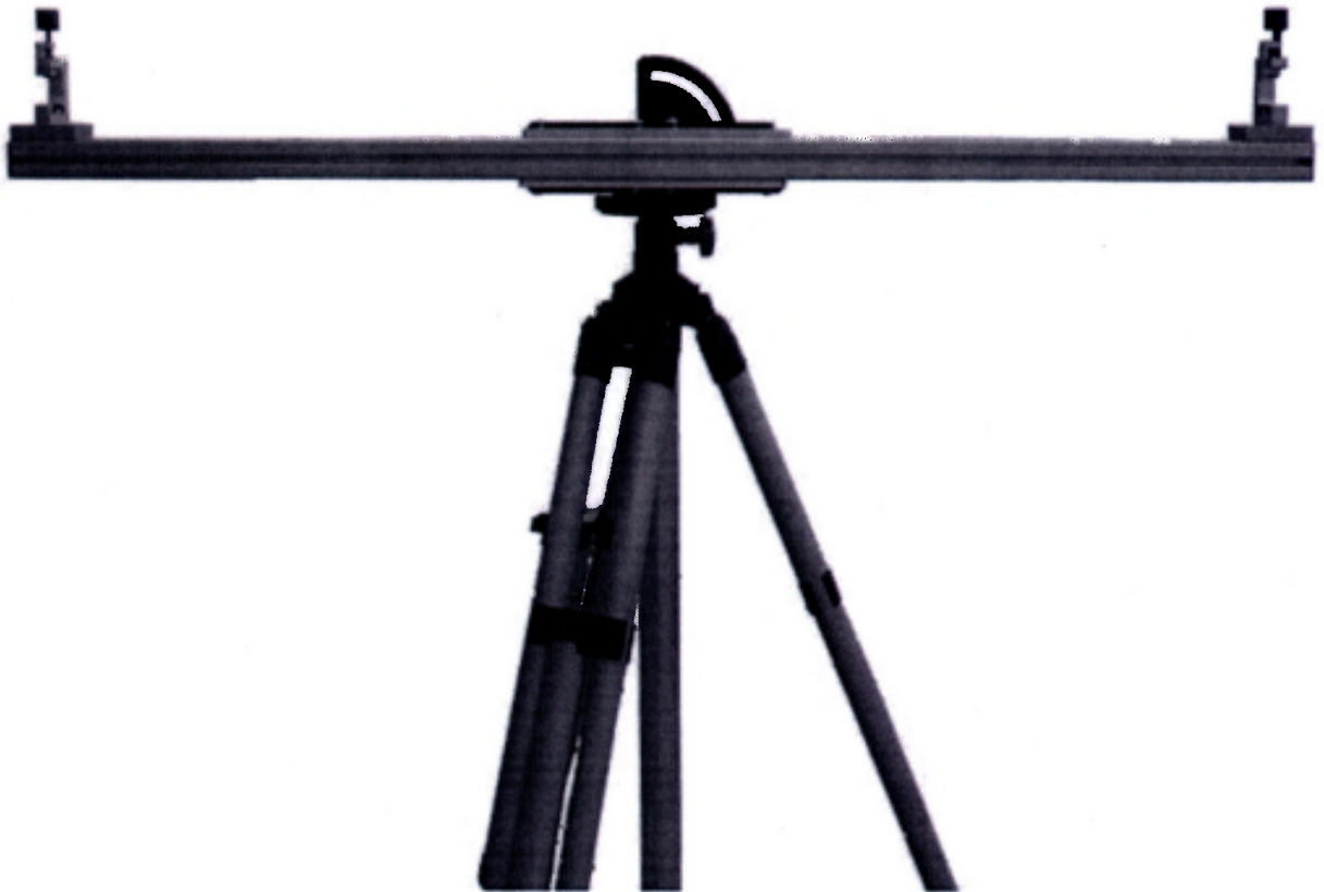
Рисунок 1 – Общий вид меры для поверки системы
