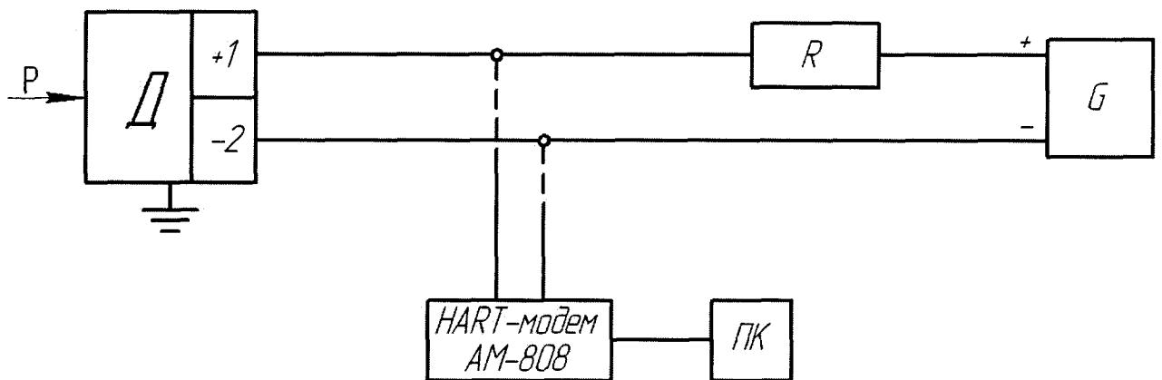
Модем – устройство связи и преобразования сигналов HART/RS232/USB; ПК – персональный компьютер;
