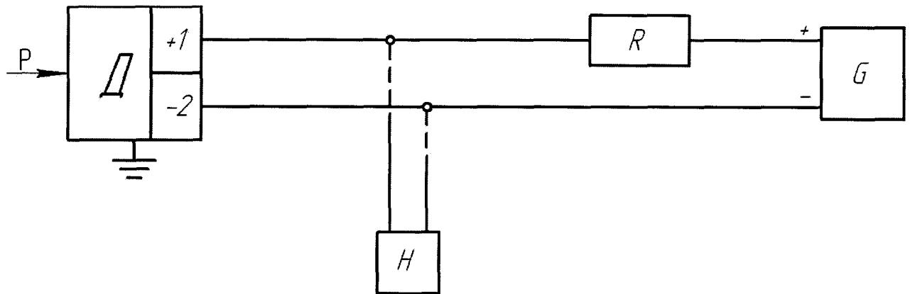
P – входная измеряемая величина; Д – поверяемый преобразователь; G – источник питания постоянного тока; R – нагрузочное сопротивление; значение сопротивления – в соответствии с условиями поверки; Н – портативный компьютер или другое цифровое устройство, поддерживающее коммуникационный протокол;
