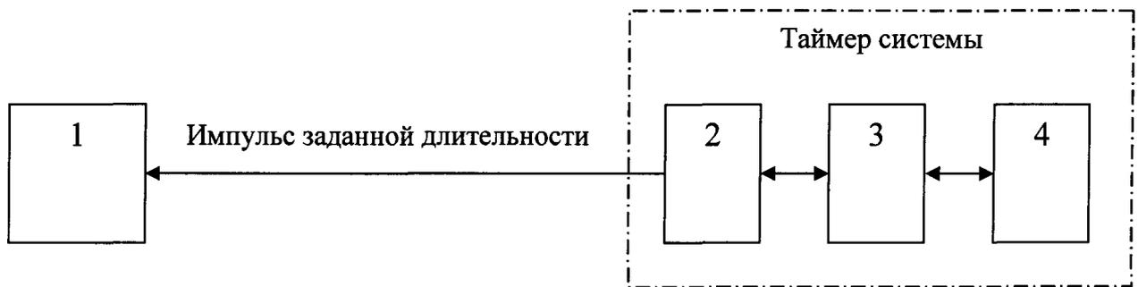
1 - частотомер универсальный CNT-90 в режиме измерения длительности импульсов (рабочий эталон);
