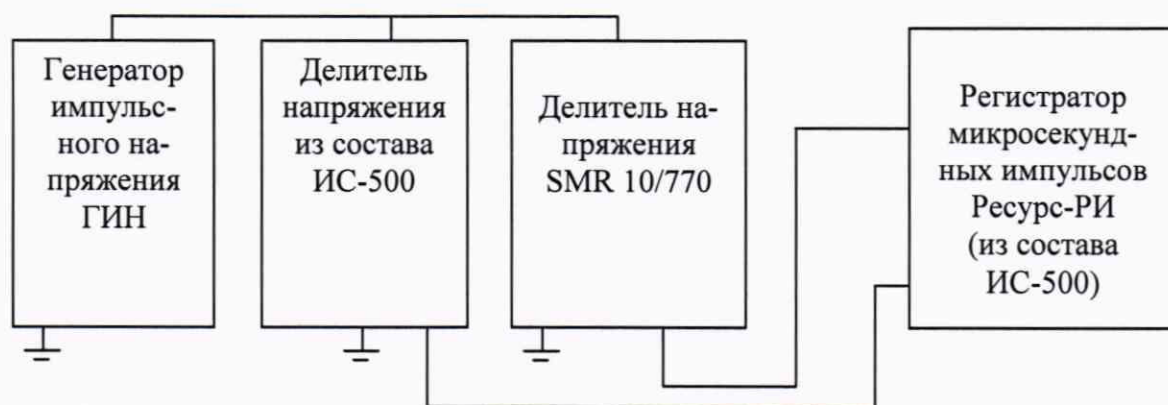
Рисунок 1 - Схема проверки относительной погрешности коэффициентов масштабного преобразования до 250 кВ
