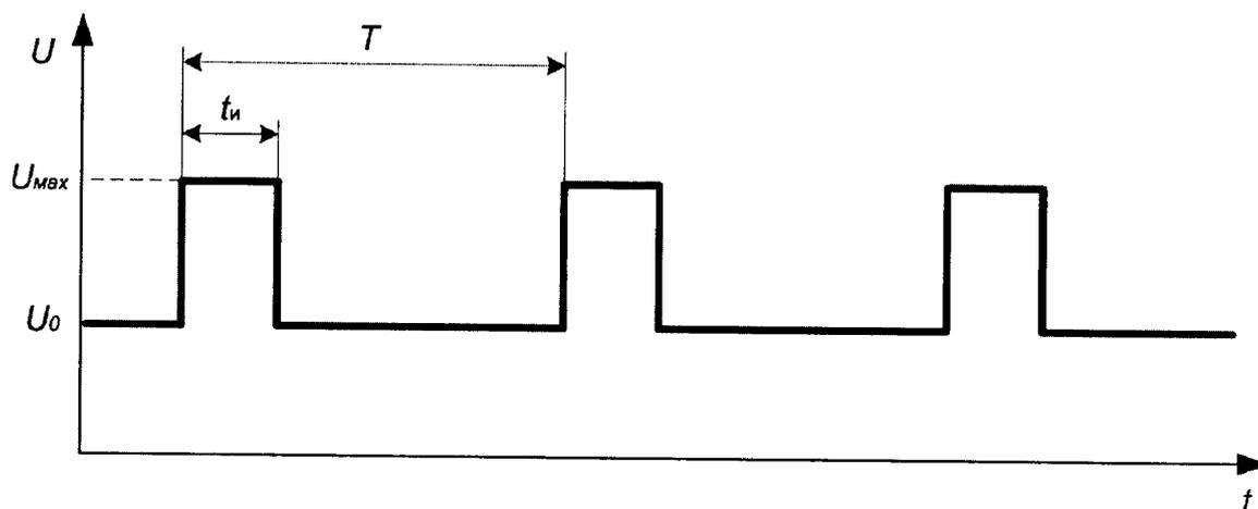
Рисунок 7.1 – Форма сигнала генератора для проверки канала измерения частоты вращения::
