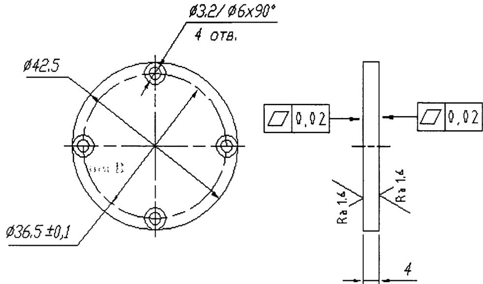
Рисунок В.3 – Конструкция образца металла для установки в юстировочное устройство
