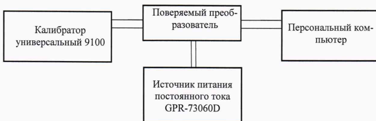
Рисунок 1 – Схема структурная определения погрешностей измерений и преобразований преобразователя
