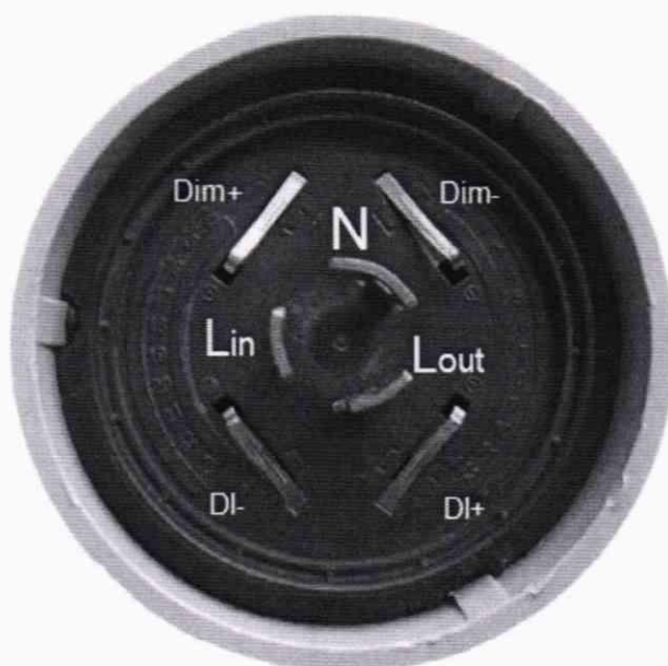
Рисунок 1 – Обозначение выводов устройства
