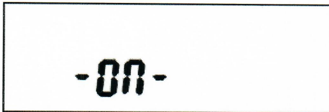
Рисунок Д.1 – Изображение символа готовности оптопорта к работе
