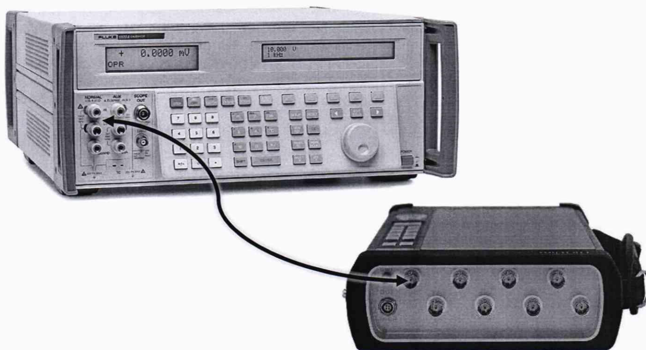
Рисунок 3 – Структурная подключения прибора к калибратору
