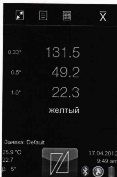
Рисунок 3 – Вид экрана ретрорефлектометра после проведения измерения.
