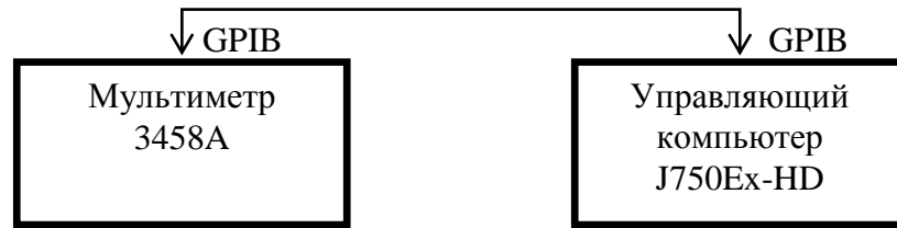
Рисунок 1 – Схема подключения кабеля GPIB для калибровки модуля «CAL-CUB»
