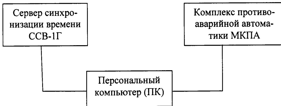
Рисунок 3 - Схема определения абсолютной погрешности измерений интервала времени
