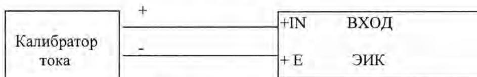
Рисунок 1 Схема соединений с эталонным калибратором силы постоянного тока
