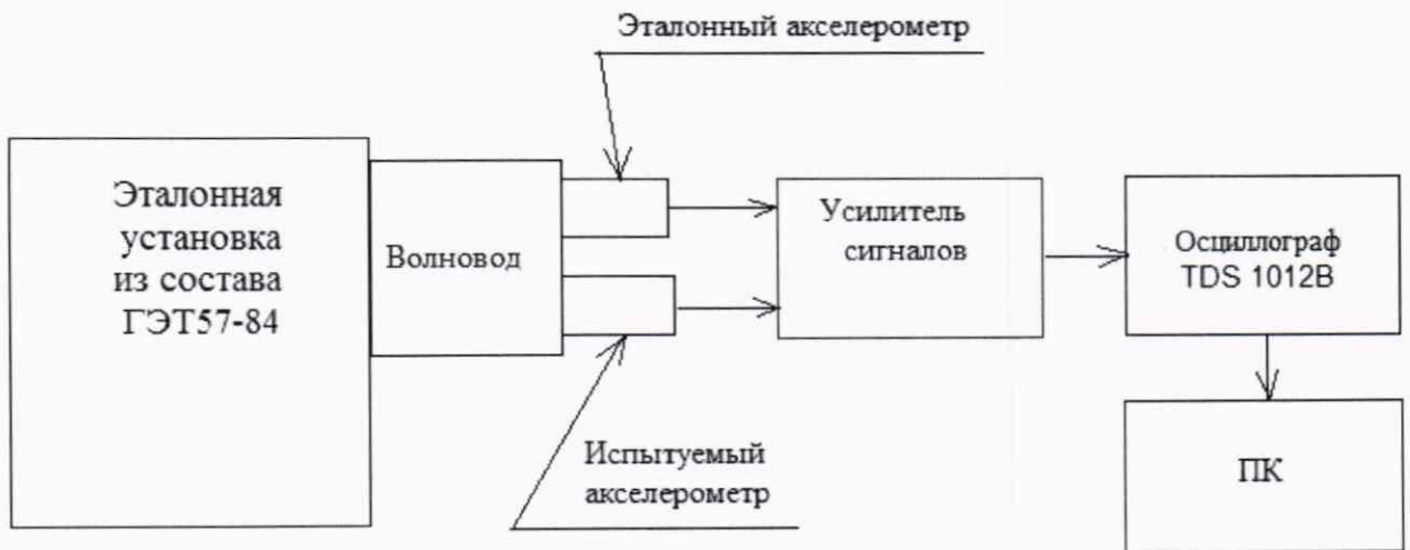
Рисунок А.1 – Схема подключения акселерометра при определении коэффициента преобразования, проверки диапазона амплитуд преобразуемых ударных ускорений
