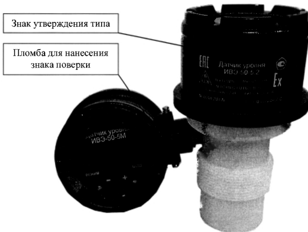
Рисунок 1Б – Схема пломбировки от несанкционированного доступа, обозначение мест нанесения знака поверки и знака утверждения типа
