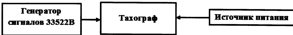
Рисунок 4 – Схема проведения измерений при определении инструментальной погрешности измерения скорости по датчику движения
