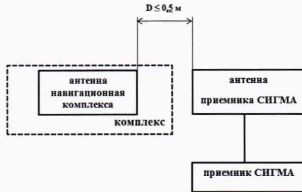
Рисунок 2 - Схема проведения измерений при определении погрешности определения координат местоположения
