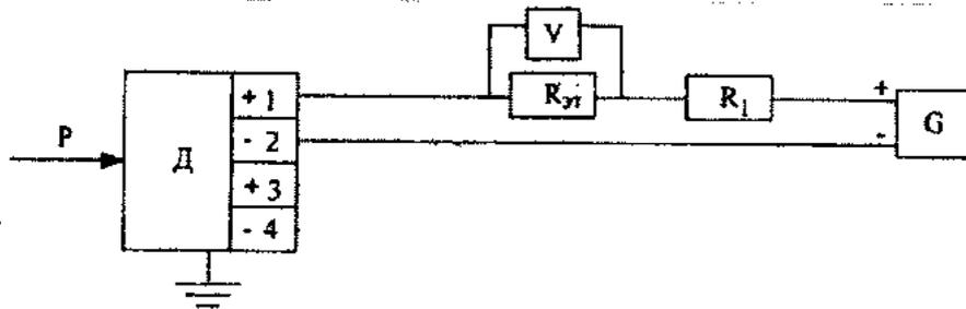
В – цифровой вольтметр или компаратор напряжения постоянного тока, указанные, например, в табл.1;
