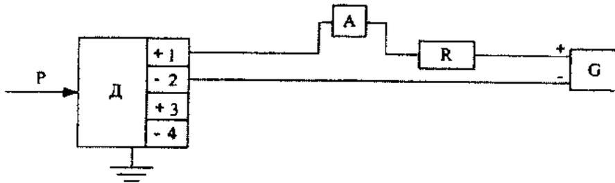
Р – входная измеряемая величина (примеры подключения к датчику эталонных СИ входной величины и эталонных задатчиков давления приведены на схемах 8 и 9 соответственно);
