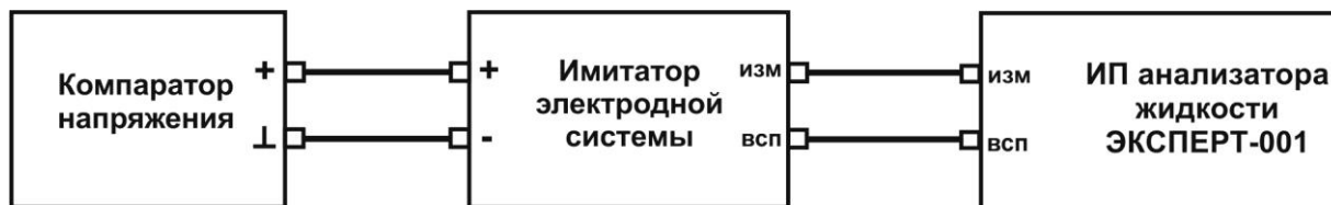
Рисунок А.4 – Схема установки для определения дополнительной абсолютной погрешности измерений рН, вызванной с изменением сопротивления измерительного и вспомогательного электродов
