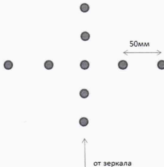
Рисунок 4 – Схема расположения стержней миры
