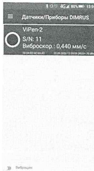
Рисунок 3 – Отображение виброметра «ViPen-2» № 11 в ПО «Беспроводные датчики DIMRUS».
