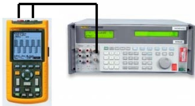
Рисунок 2. Схема соединения приборов для проверки параметров входа осциллографа А и В, используя выход «SCOPE OUT» калибратора 5520А.
