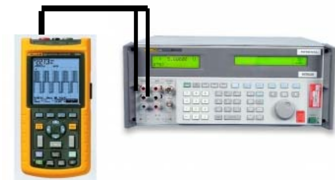
Рисунок 5. Схема соединения приборов для определения погрешности измерения сопротивления только по входу А.
